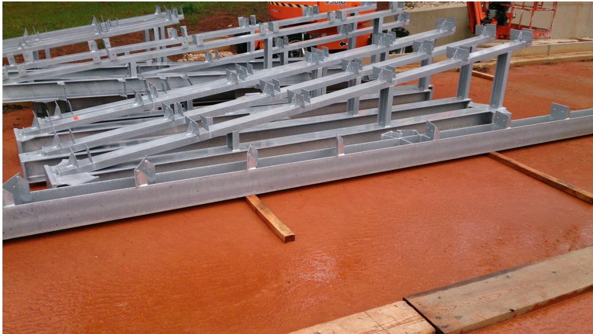
Slika 17. Prikaz izrađenog i pocinčanog segmenta
