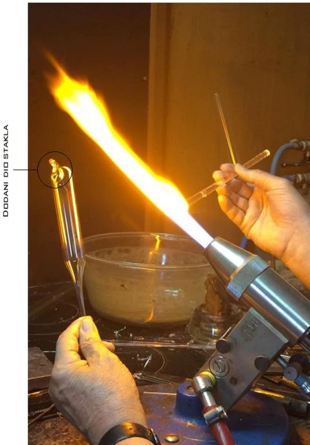
Slika 5.20. Taljenje staklene šipke
