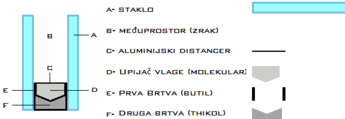
Slika 4.7. Struktura izolacijskog stakla
