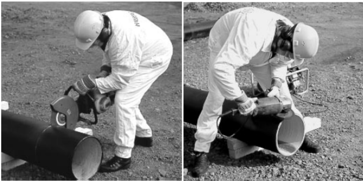
Slika 6.4.1. Primjer rezanja i skošivanja cijevi [8]
