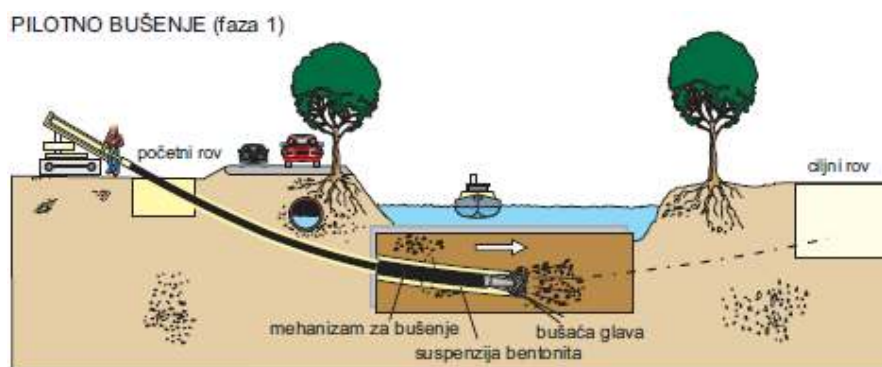
Slika 4.8.2.1. Metoda horizontalnog bušenja faza 1. [8]
