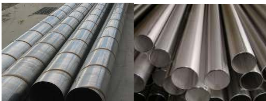
Slika 4.4.2.2. Šavne čelične cijevi; (a) dobivene spiralnim zavarivanjem; (b) dobivene uzdužnim zavarivanjem [9]
