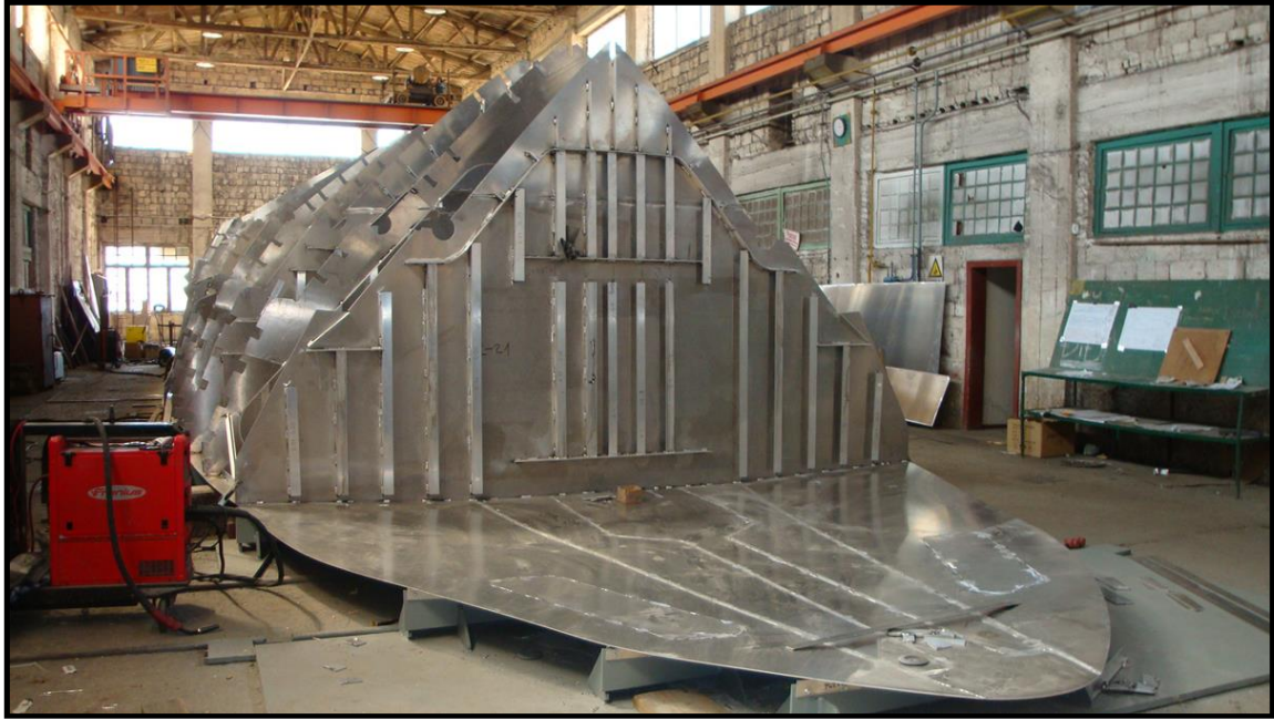
Slika 6: Gradnja brodskog trupa na glavnoj palubi
