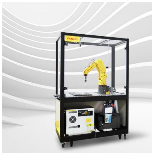
Slika 12. Edukacijski paket robota FANUC ER-4iA sa zaštitnim spremnikom Izvor: https://www.fanuc.eu/hu/en/robots/educational-package , preuzeto 16.09.2023.
