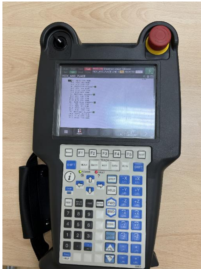
Slika 11. „Teach pendant“ upravljački uređaj robota Izvor: autor
