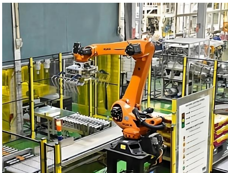
Slika 3. Primjer robota koji se koristi za metodu „pick and place“ kod sastavljanja
