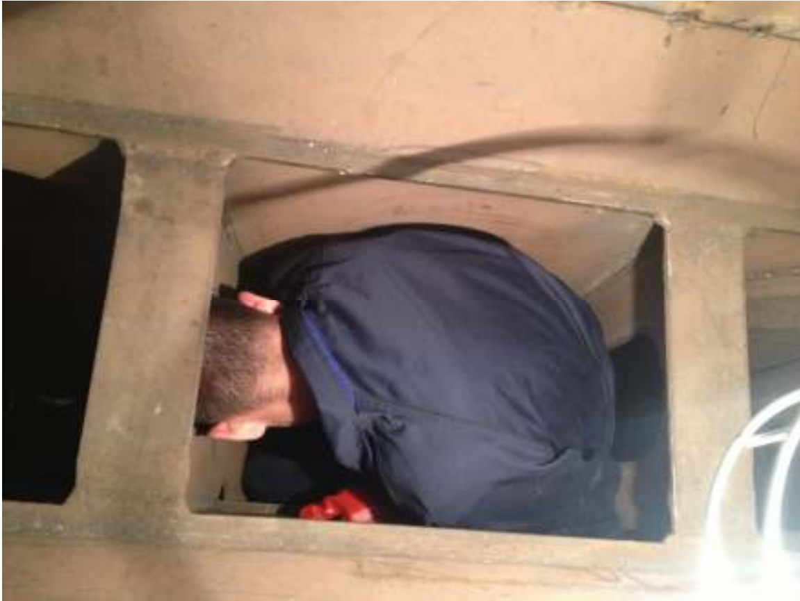
Slika 17. Nanošenje penetranta po zavarima kobilice.
