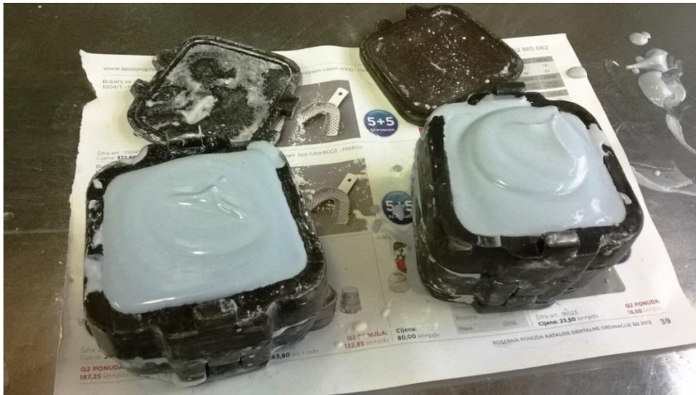
Slika 4.48. Kivete spremne za zatvaranje
