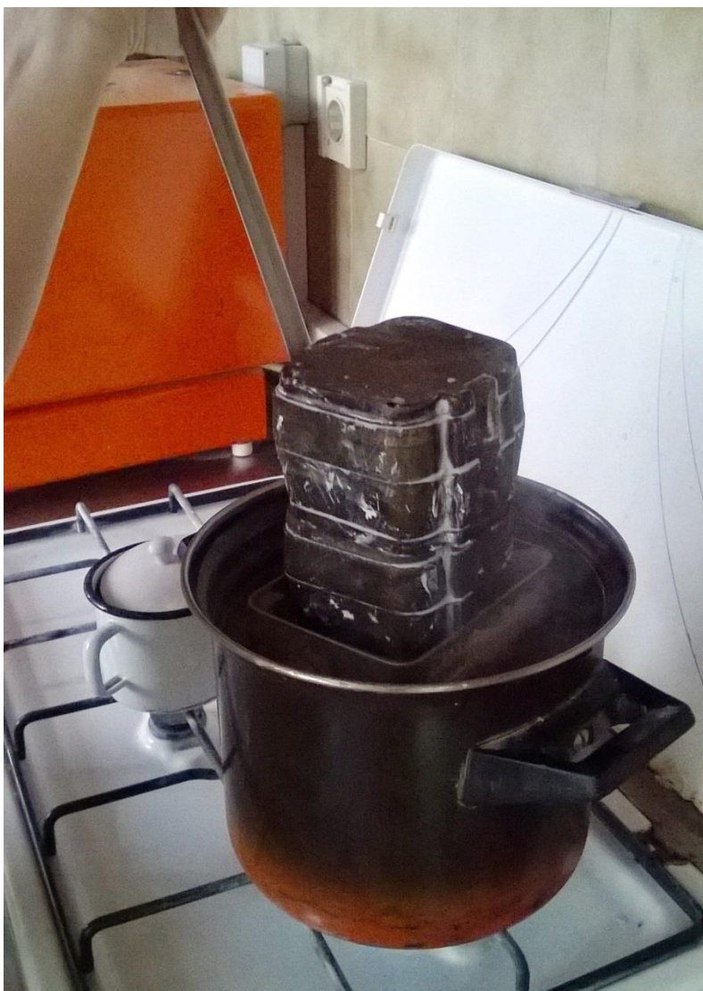
Slika 4.50. Uranjanje kiveta u kipuću vodu pomoću držača za kivete
