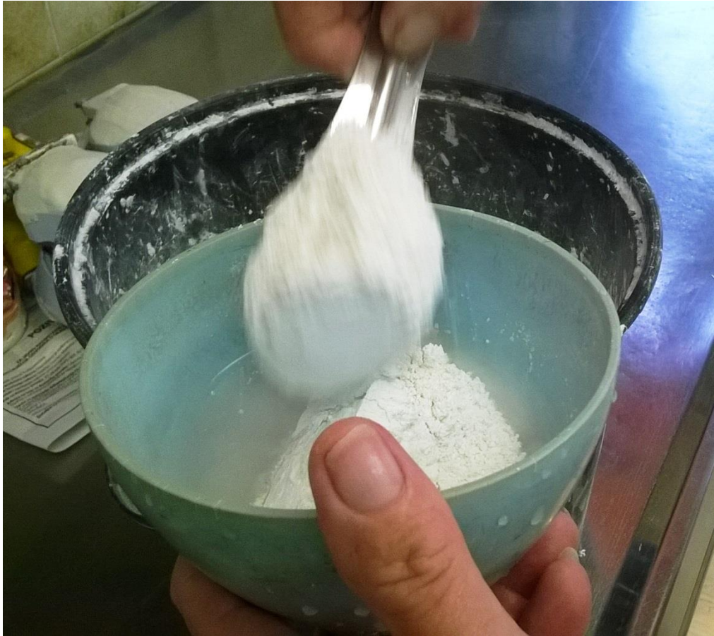
Slika 4.3. Miješanje alabaster-gipsa u gumenoj posudi sa vodom pomoću ravne inox-lopaticice
