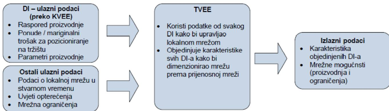
Slika 4.4.3 Aktivnosti tehničke virtualne elektrane; Izvor: [www.ho-cired.hr](http://www.ho-cired.hr)
