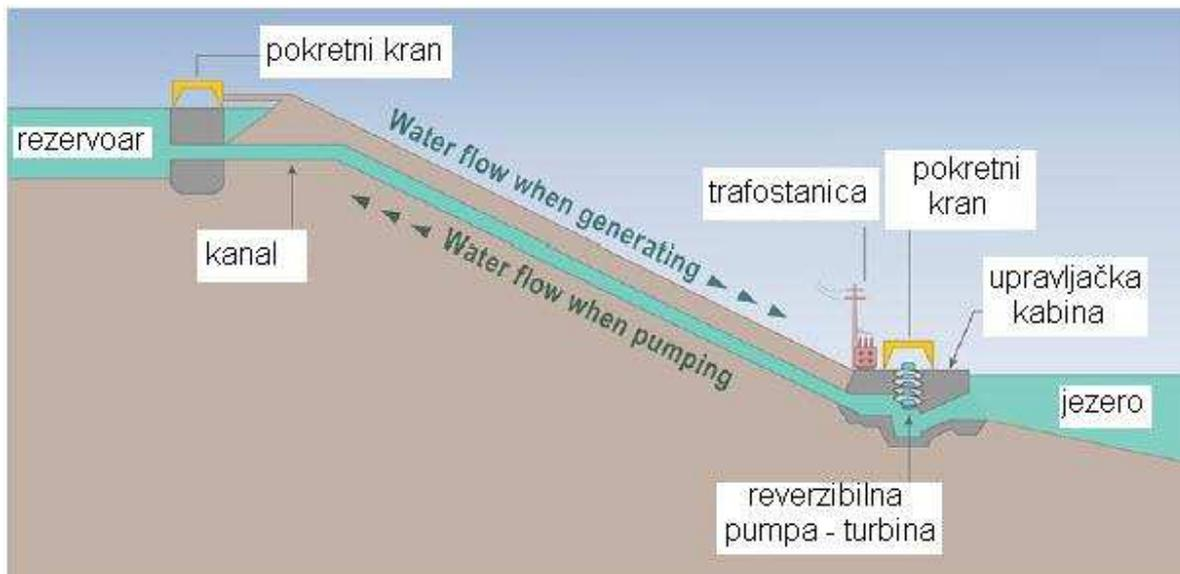
Slika 4.3.1 Reverzibilna hidroelektrana; Izvor: [www.decarboni.se](http://www.decarboni.se)
