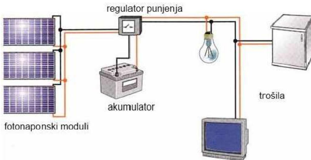
Slika 6.2.1 Autonomni fotonaponski sustav za trošila na istosmjernu struju; Izvor: [www.flamtron.hr](http://www.flamtron.hr)
