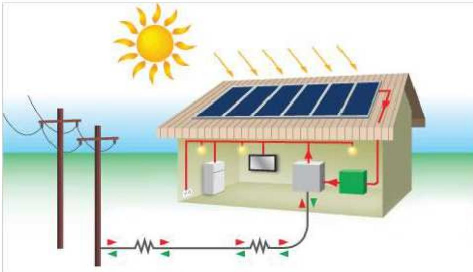
Slika 6.2.2 Fotonaponski sustav priključen na javnu mrežu preko kućne instalacije; Izvor: [www.hsuse.hr](http://www.hsuse.hr)
