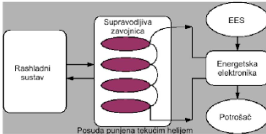
Slika 4.3.2 Supravodljivo magnetsko skladištenje energije; Izvor: [www.fer.unizg.hr](http://www.fer.unizg.hr)
