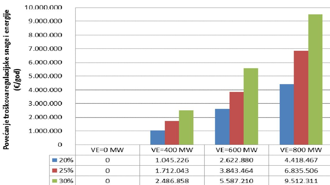
Dijagram 6.1.3 Povećanje troškova regulacijske snage i energije u ovisnosti o instaliranoj snazi VE i kvaliteti prognoze proizvodnje VE; Izvor: www.hera.hr
