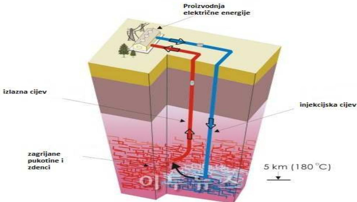
Slika 2.4 Proizvodnja električne energije pomoću geotermalne energije; Izvor: [www.powerlab.fsb.hr](http://www.powerlab.fsb.hr)
