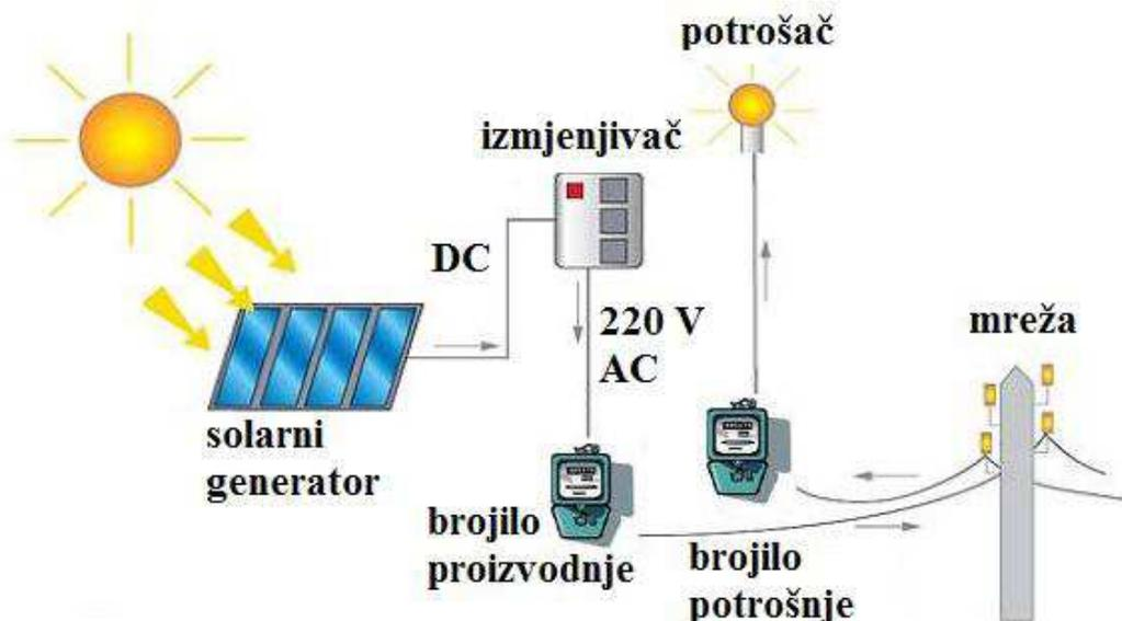
Slika 6.2.3 Fotonaponski sustav izravno priključen na javnu elektroenergetsku mrežu; Izvor: [www.powerlab.fsb.hr](http://www.powerlab.fsb.hr)
