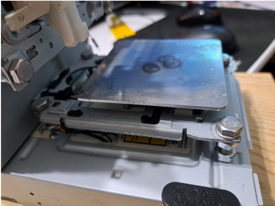
Slika 17: Pločica za držanje papira od aluminija
