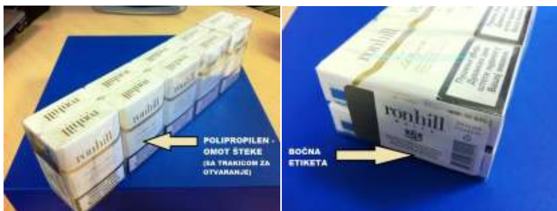
Slika 31: PP šteka – pozicija u finalnom proizvodu i jedinica rukovanja
