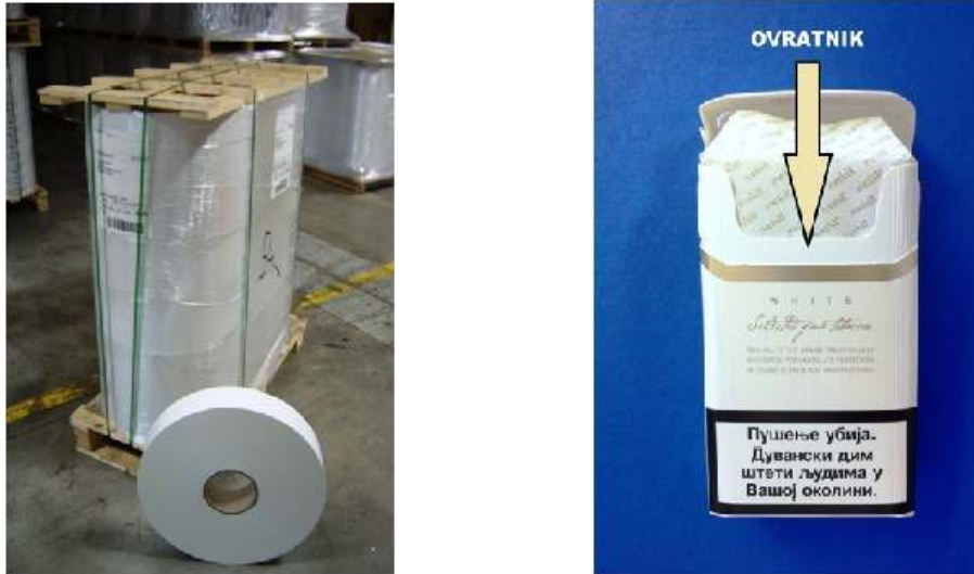
Slika 25: Ovratnik – pozicija u finalnom proizvodu i jedinica rukovanja
