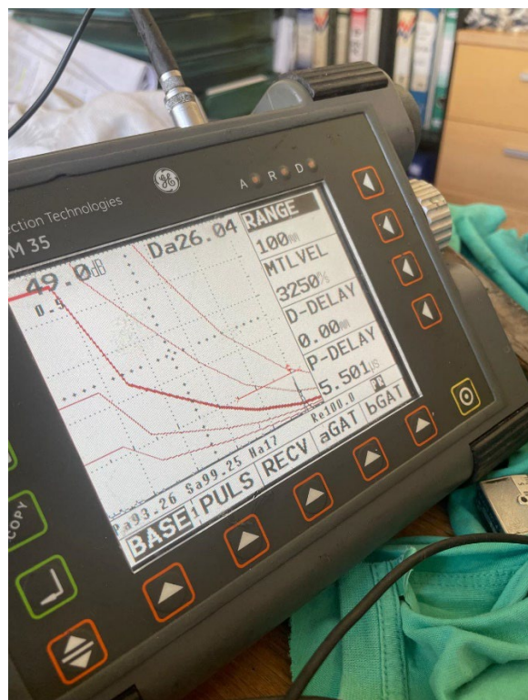
Slika 19 USM 35 uređaj pri kalibraciji
