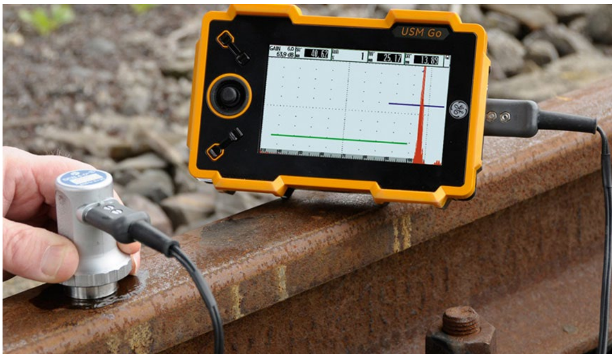
Slika 10 Primjer ultrazvučne metode ispitivanja
