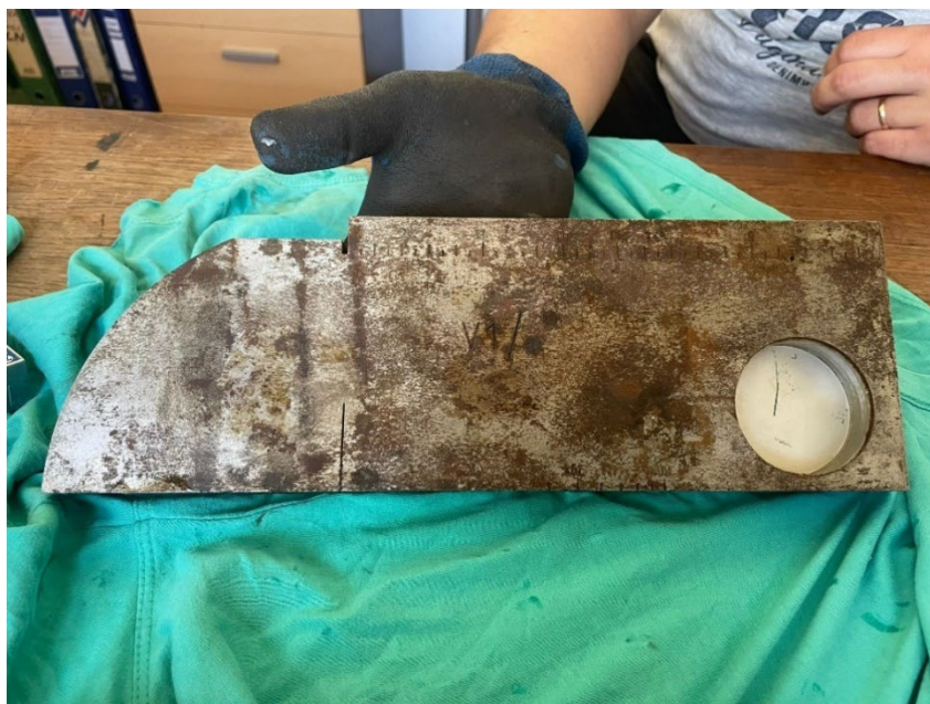
Slika 17 V1 Etalon za kalibraciju UZV uređaja
