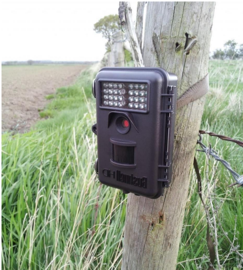
Slika 2: Primjer moderne kamere za fotografiranje divljih životinja s automatskim okidanjem. Izvor: https://naturespy.org/camera-traps-science/
