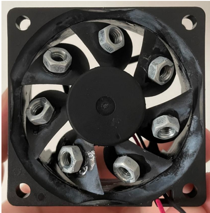
Slika 38: Dodatak matica na ventilator
