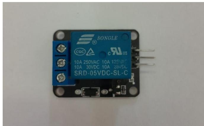
Slika 17: Fotografija relejskog modula kompatibilnog s Arduino UNO.
