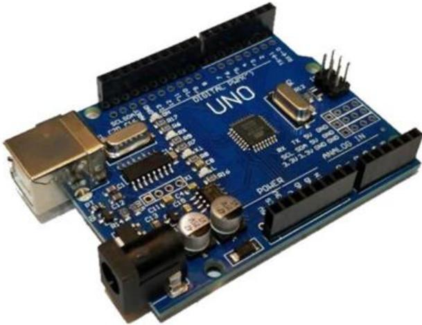
Slika 14: Prikaz Arduino UNO pločice. Izvor:
