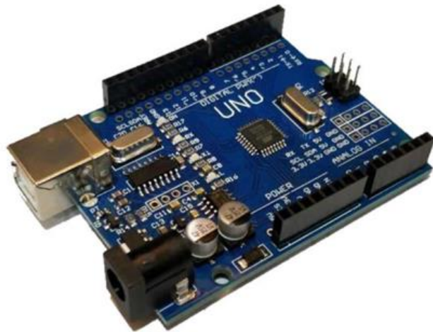
Slika 14: Prikaz Arduino UNO pločice. Izvor:
