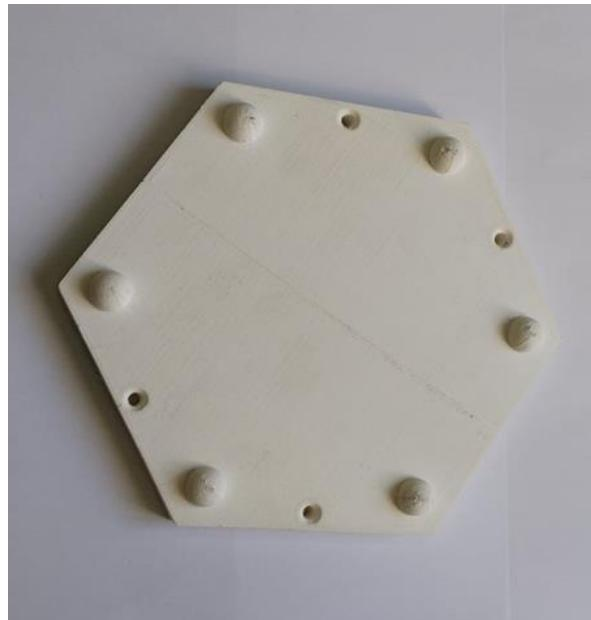
*Slika 7: Fotografija donje ploče kućišta s pripadnim nožicama.*
