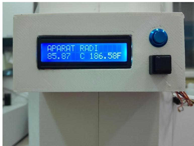
Slika 5: Fotografija kućišta za LCD zaslon s tipkalima.
