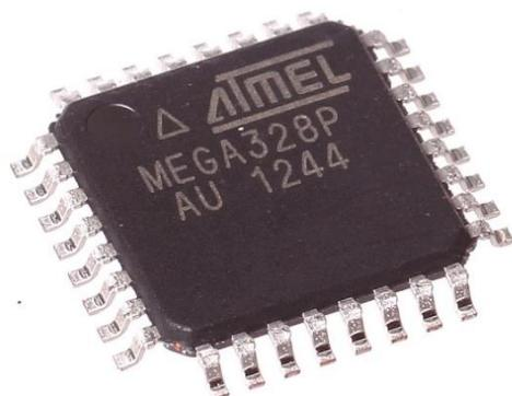
Slika 15: Prikaz mikrokontrolera ATmega328P. Izvor:
