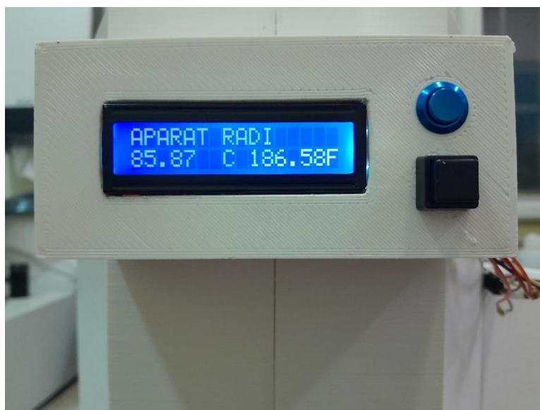
Slika 5: Fotografija kućišta za LCD zaslon s tipkalima.
