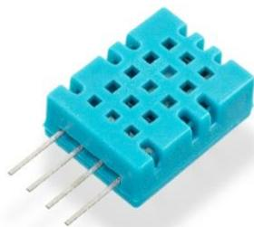
Slika 14. DHT11 senzor za mjerenje temperature i vlage
