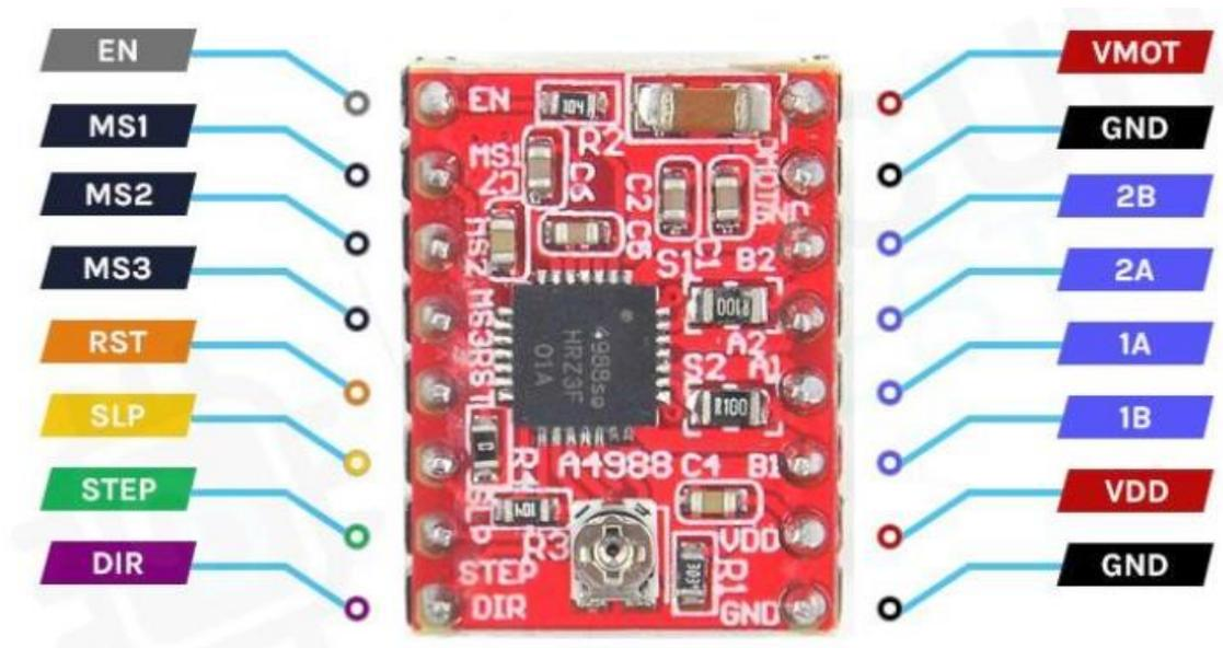
Slika 8. A4988 driver za upravljanje NEMA17 koračnim motorom
