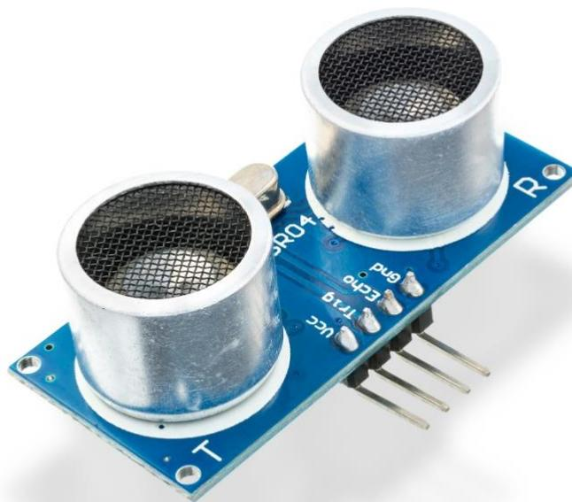
Slika 11. Ultrazvučni senzor HC-SR04
