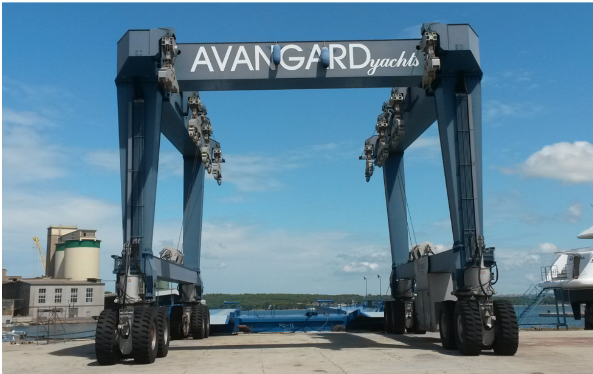
Slika 1. 500t "Travel lift" u Pulskom brodogradilištu Avangard (Izvor: Internetski portal www.avangard-yachts.com )
