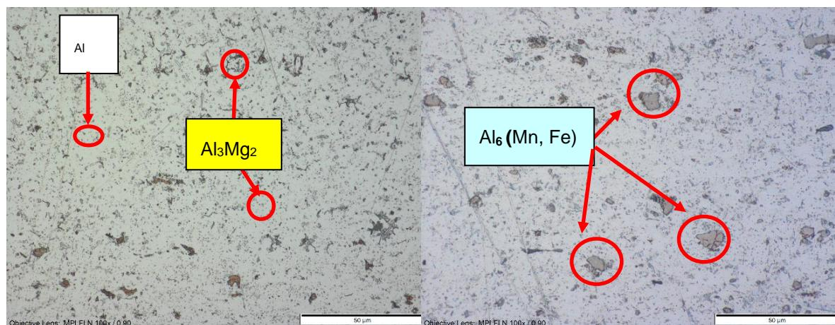
c) Mikrostruktura uzorka pri povećanju od
