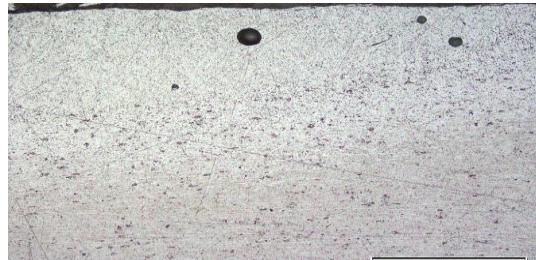
b) Mikrostrukturna analiza uzorka (P1), područja zone utjecaja topline (ZUT), nakon ravnjanja limova sa TIG opremom
