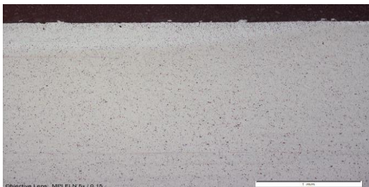
e) Mikrostrukturna analiza uzorka (P4), područja zone utjecaja topline (ZUT), nakon ravnanja limova TIG opremom
