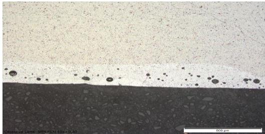
c) Mikrostrukturna analiza uzorka (P2), područja zone utjecaja topline (ZUT), nakon ravnjanja limova sa TIG opremom
