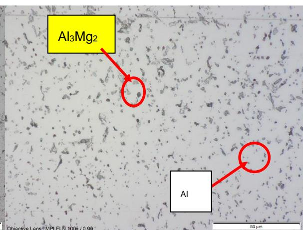
d) Mikrostruktura uzorka pri povećanju od 1000x – čisti ZUT
