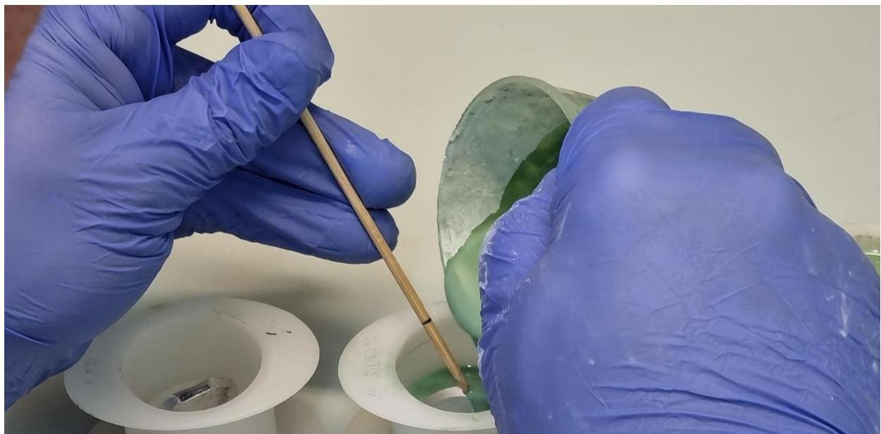
Nakon protoka 24 sata, uzorke je potom potrebno obraditi, tako da se postupno skidaju slojevi, brušenjem i poliranjem, kako bi se uklonio tanki sloj korozije i nečistoća koji je nevidljiv golim okom. Navedene nečistoće su mogле nastati prijenosom s ploče za rezanje, kalupa, radnog stola ili bilo kojeg vanjskog faktora.
