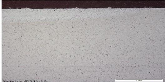
e) Mikrostrukturna analiza uzorka (P4), područja zone utjecaja topline (ZUT), nakon ravnjanja limova TIG opremom
