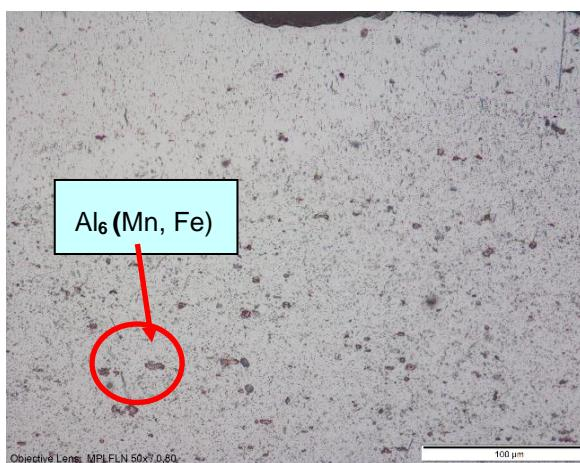
b) Mikrostruktura uzorka pri povećanju od 100x
