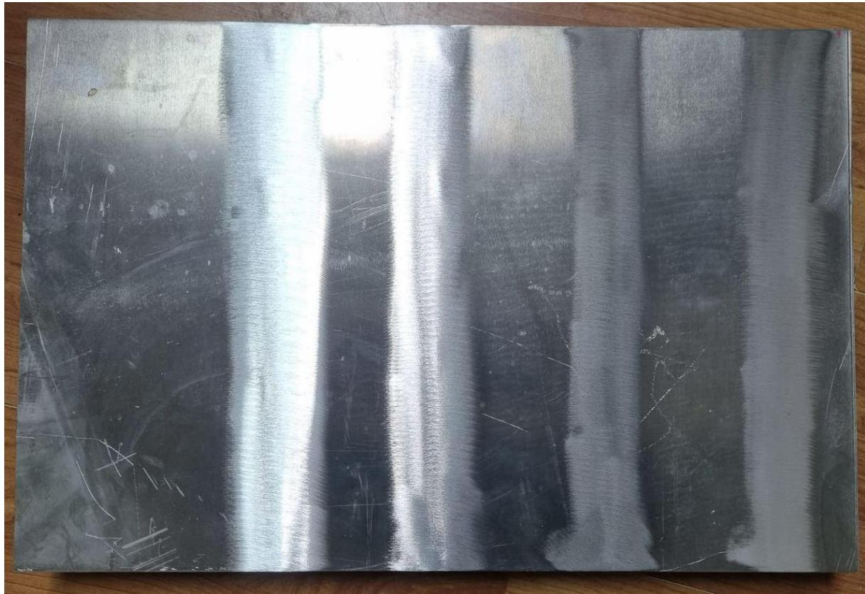
Lim na kojem je odrđena TIG procedura ravnjanja izrezan je na manje epruvete, promjera 40 mm (slike 5 i 6), koje se naknadno detaljnije prilagođava, u laboratoriju, kako bi bile pogodne za promatranje na mikroskopu.
