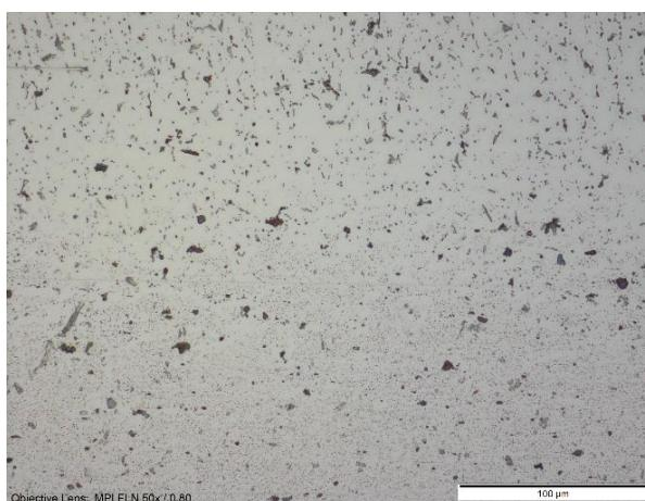
c) Mikrostruktura uzorka pri povećanju od 500x – čisti ZUT
