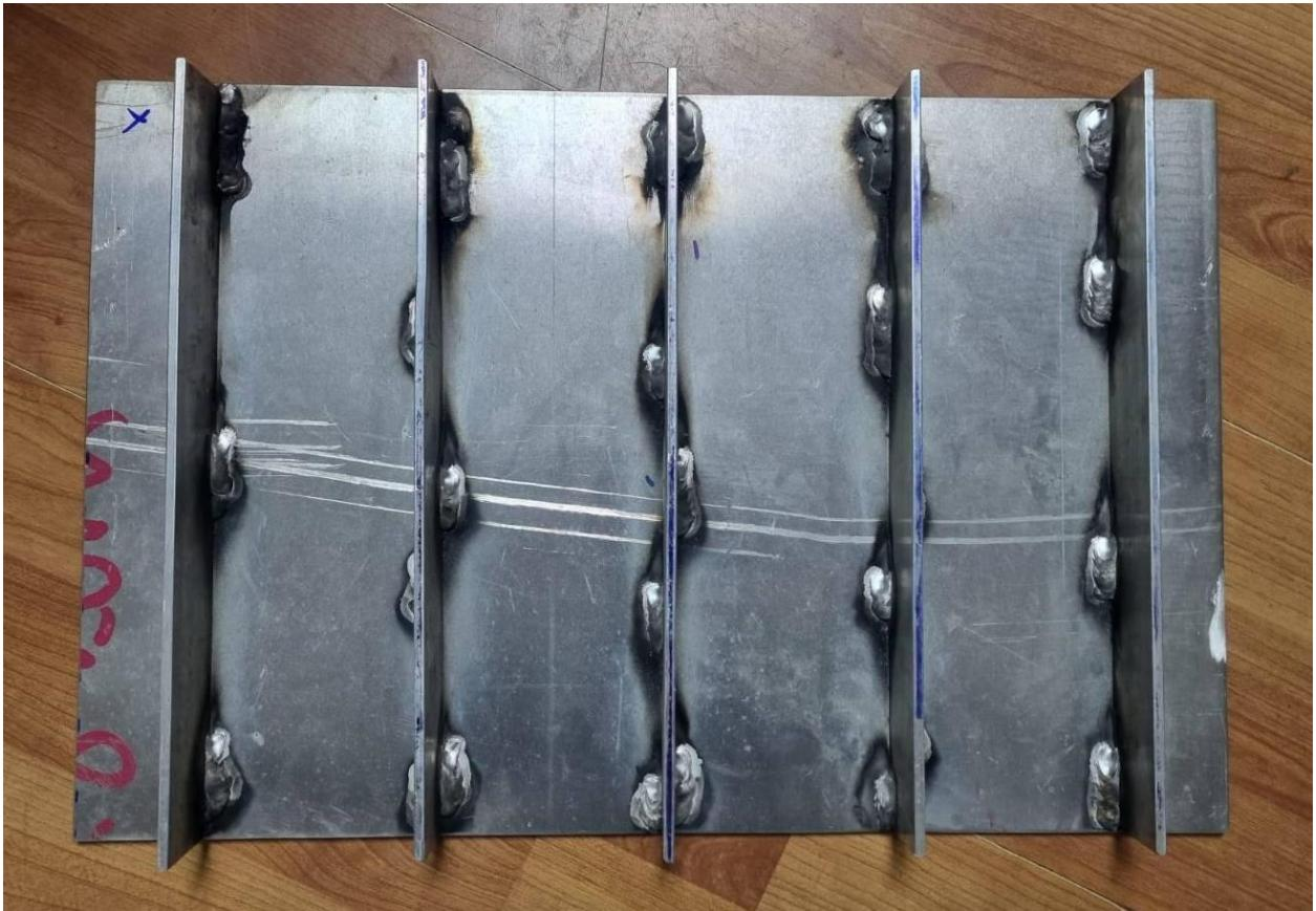
Na površini koja simulira trup boda, na kojoj se vrši unos topline, odstranjen je aluminijev oksid na četiri od šest uzoraka, od kojih je jedan referentni. Tako pripremljen „trup“ je spremam za unos topline koji se vrši prema nekoliko različitih vrijednosti unosa topline odnosno uvjeta. Zbog povjerljivih podataka poduzeća Tehnomont brodogradilište d.o.o. nije moguće otkriti sve parametre, no formula po kojoj je dobivena količina unosa topline je:
