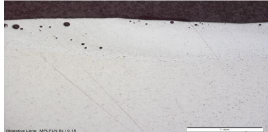
f) Mikrostrukturna analiza uzorka (P5), područja zone utjecaja topline (ZUT), nakon ravnjanja limova sa TIG opremom
