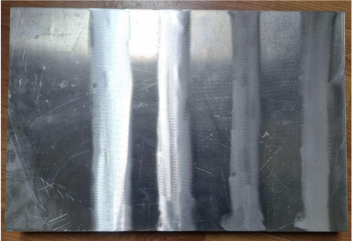
Slika 4. Odstranjen površinski sloj \text{Al}_2\text{O}_3
