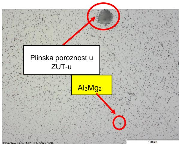
b) Mikrostruktura uzorka pri povećanju od 200x
