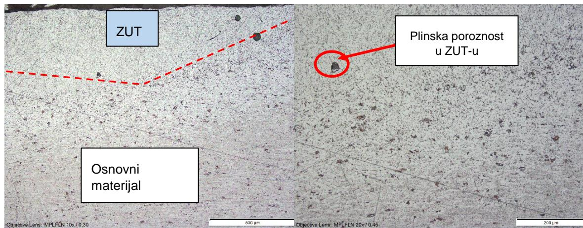
a) Mikrostruktura uzorka pri povećanju od
