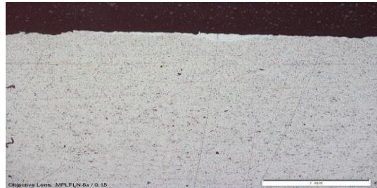
d) Mikrostrukturna analiza uzorka (P3), područja zone utjecaja topline (ZUT), nakon ravnjanja limova sa TIG opremom
