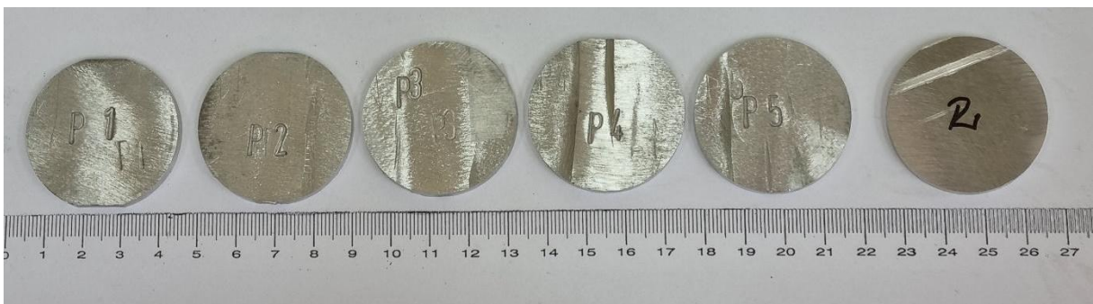
Slika 5. Uzorci neposredno prije pripreme za ispitivanje u laboratoriju odnosno prije prilagodbe za kalup
