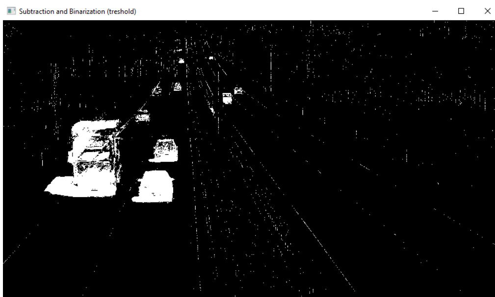
Slika 13. Prikaz morfološke operacije otvaranja i zatvaranja
