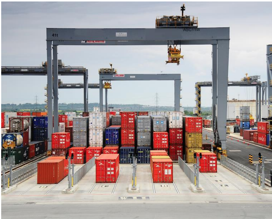
Slika 13: Automatizirana dizalica za slaganje (ASC)
