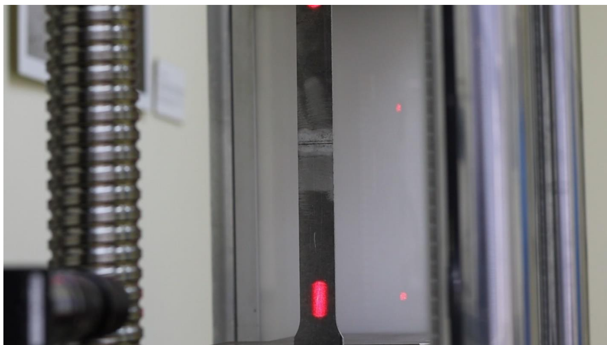
Slika 12. Uzorak na kidalici prije početka ispitivanja
