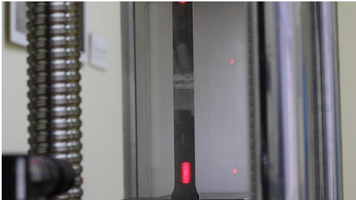
Slika 12. Uzorak na kidalici prije početka ispitivanja
