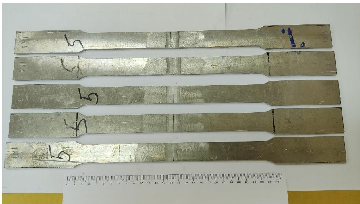
Slika 10. Ispitni uzorci za vlačno ispitivanje
