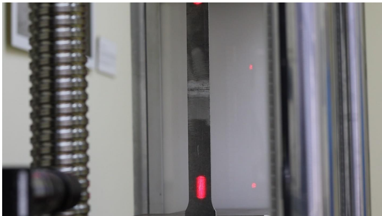
Slika 12. Uzorak na kidalici prije početka ispitivanja
