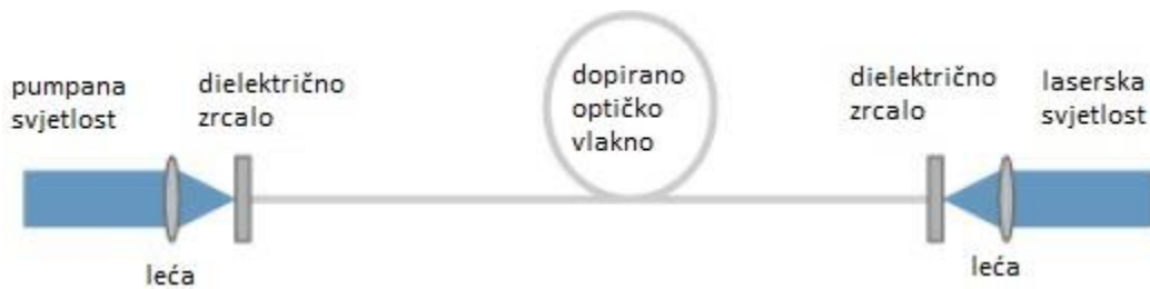
Slika 5: Shematski prikaz optičkog lasera
