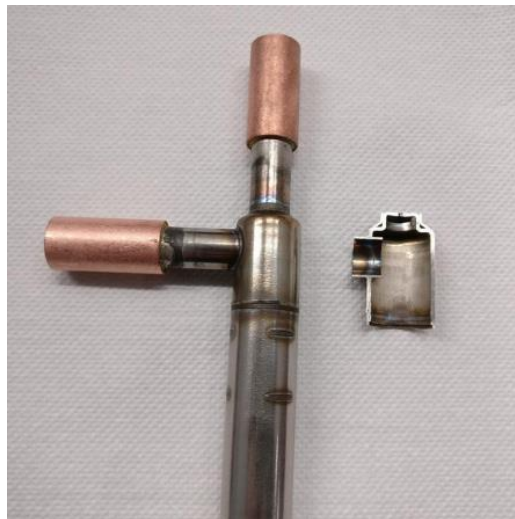
Slika 17: Primjer izrezanog ventila
