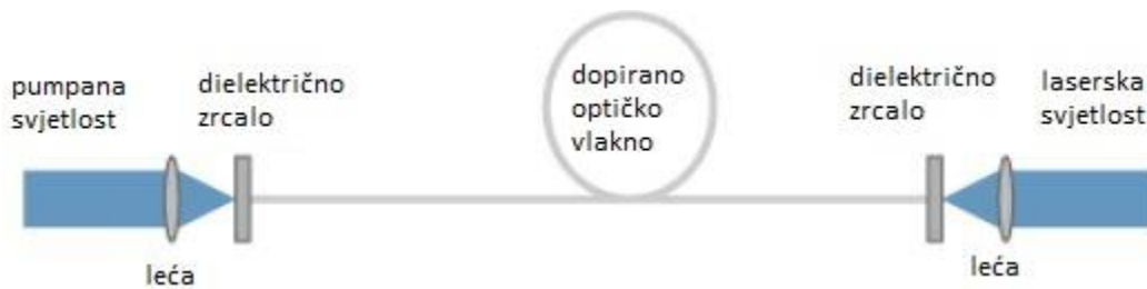
Slika 5: Shematski prikaz optičkog lasera
