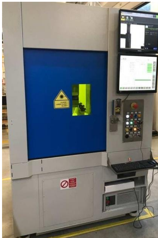
Slika 13: Stroj za zavarivanje s optičkim laserskim izvorom
