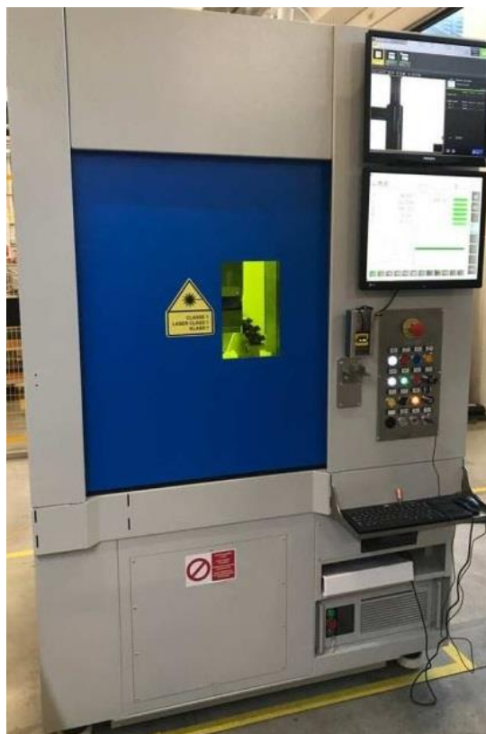
Slika 13: Stroj za zavarivanje s optičkim laserskim izvorom
