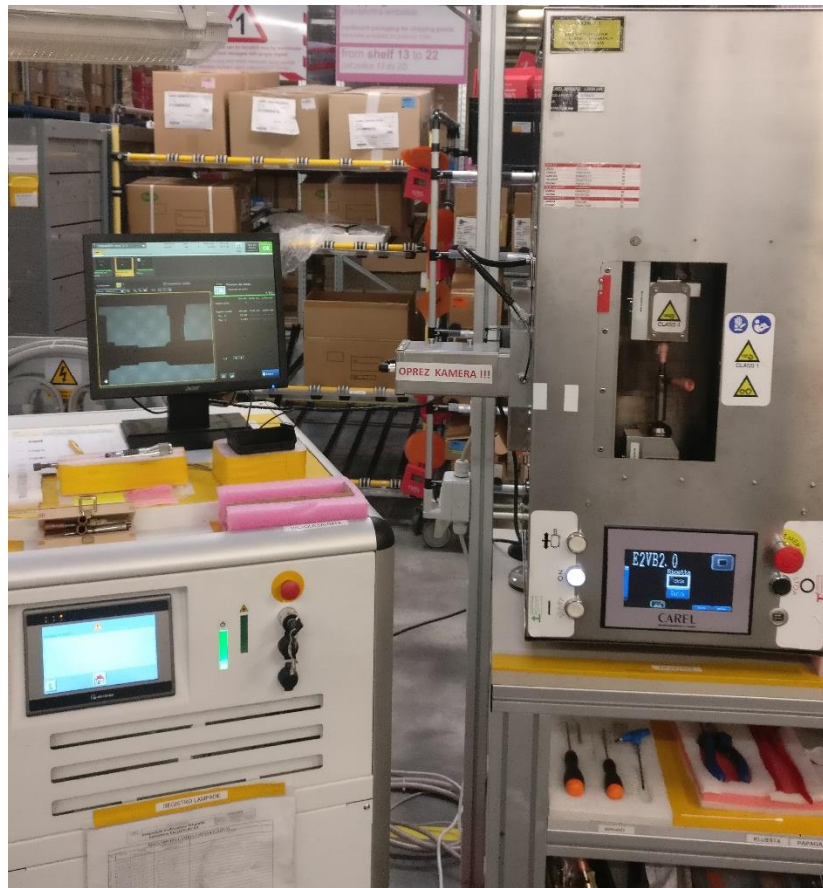
Slika 12: Izvor lasera i stroj za zavarivanje
