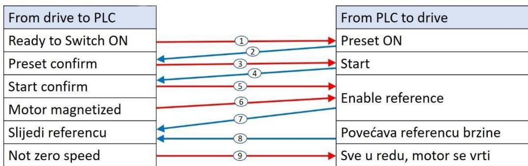
**Slika 36.** Pokretanje motora PLC-om
