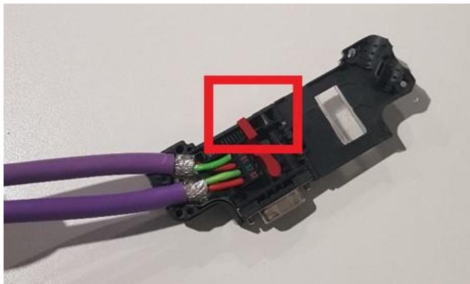
**Slika 11.** Mrežni konektor RS485 i prekidač za zaključavanje linije
