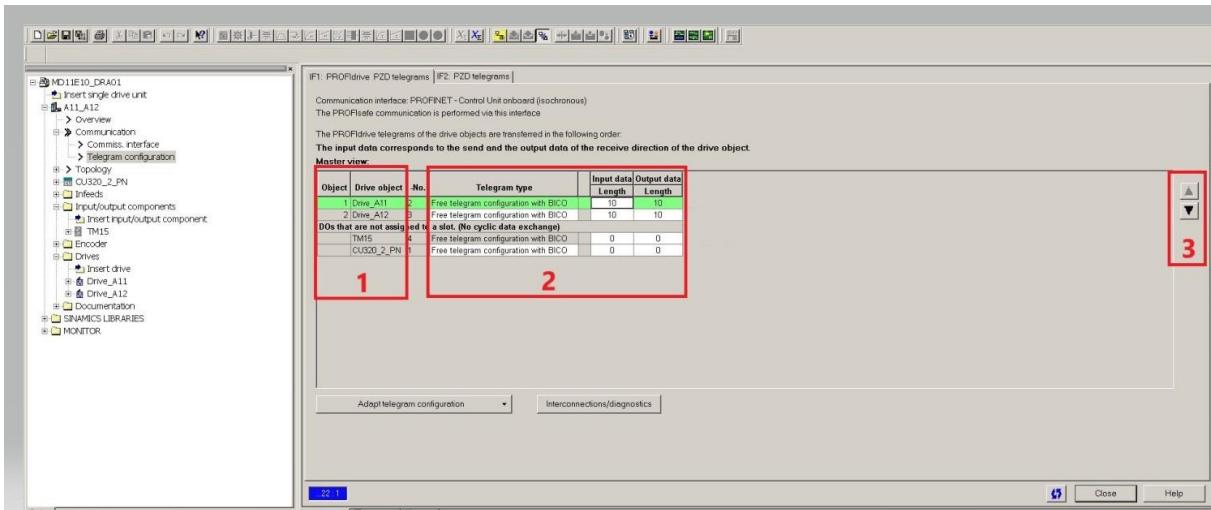
**Slika 28.** Telegram konfiguracija, Siemens Starter
