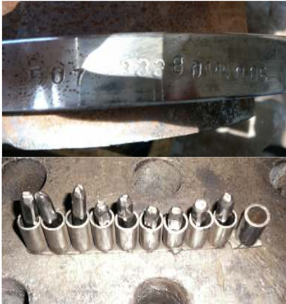
Slika 20. Brojeva za obilježavanje cijevi i obilježena cijev
