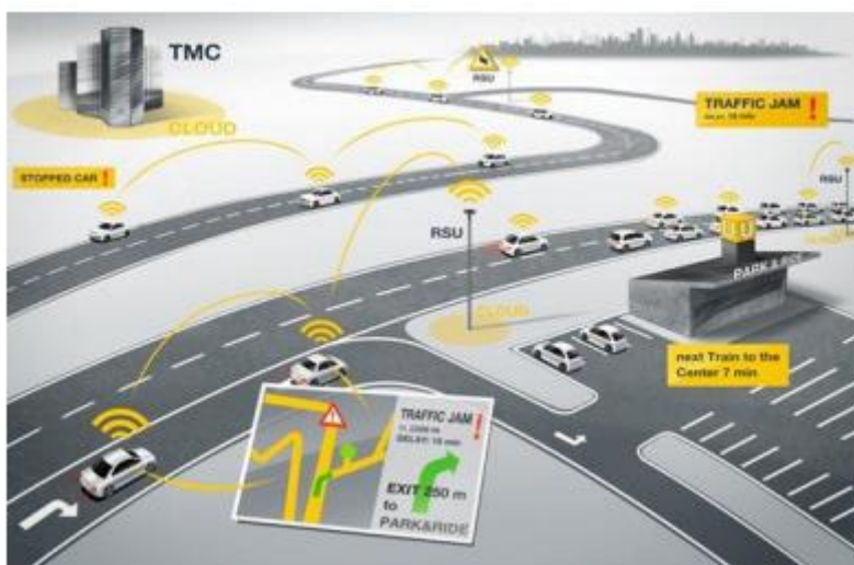
Slika 18: Komunikacija vozila i infrastrukture Izvor: https://www.kapsch.net/ , preuzeto: 10.1.2021.g.
