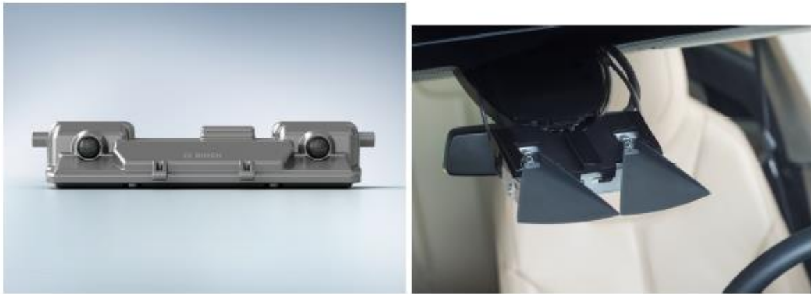
Slika 10: a) Bosch stereo video kamera, b) Lokacija kamere na prednjem staklu Izvor: H. Sjafric (2019.): Introduction to Self-Driving Vehicle Technology
