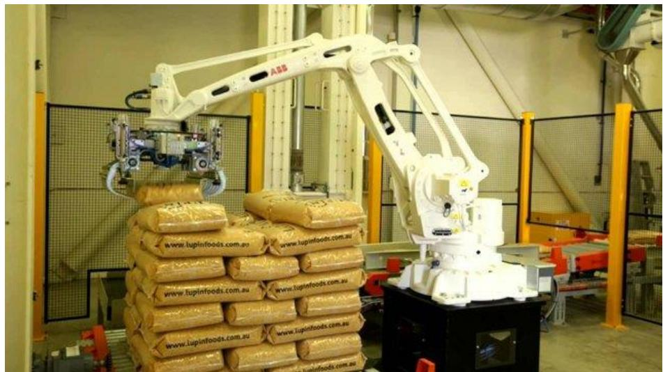
Slika 11 Prikaz industrijskog robota paletizera
