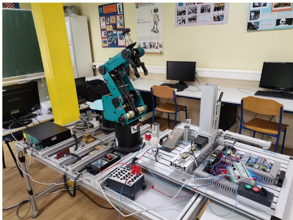
*Slika 18 Prikaz sustava za automatsko sortiranje obratka i robotsko paletiziranje*
