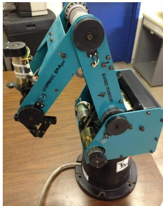
Slika 16 Prikaz Scorbaze robota sa elektroničkim sustavom
