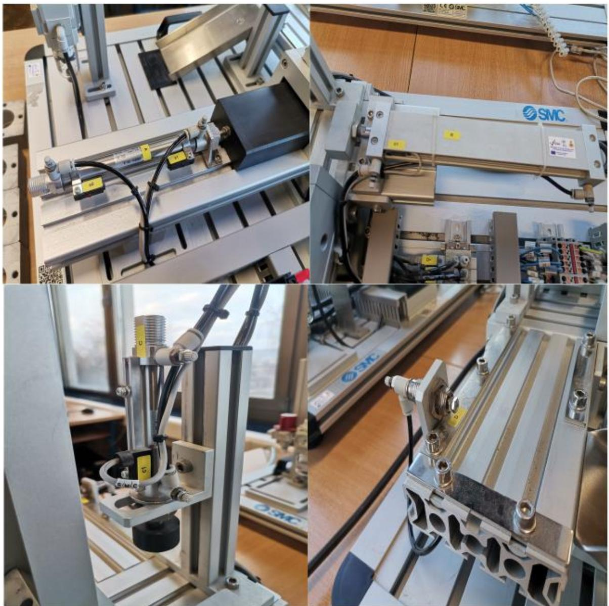
*Slika 19 Prikaz cilindara A, B, C i D te njihovih odgovarajućih senzora a0, a1, b1 i c1*
