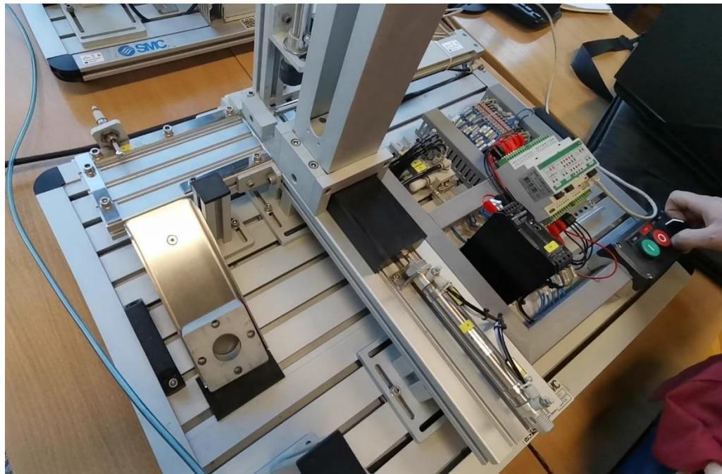
Slika 22 Prikaz izbacivanja neispravnog provrta sa trake
