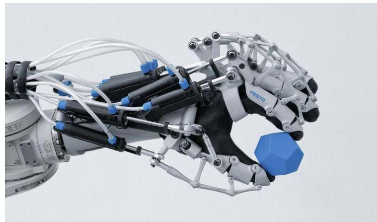
Slika 14 Prikaz primjene pneumatike u translacijskom zglobu
