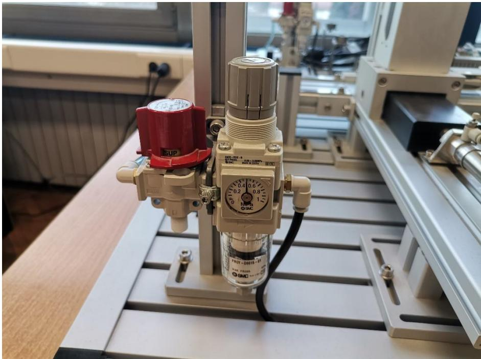
*Slika 20 Prikaz pripremne stanice za zraka i radnog tlaka zraka od 5 bar-a*
