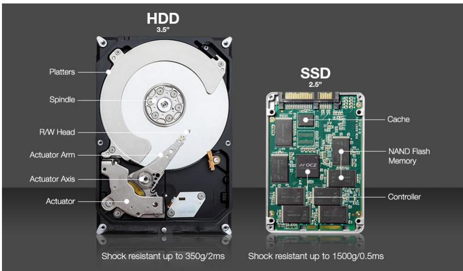
Slika 9 Fizička usporedba HDD-a i SSD-a
