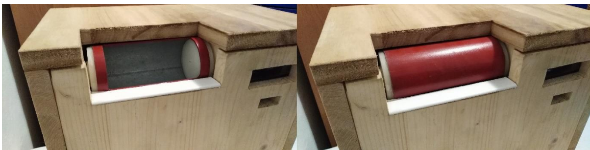
Slika 22. Pretinac za ubacivanje otpada (Izradio Autor)
