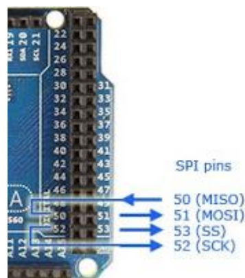
Slika 16. SPI priključci na Arduino AT Mega 2560
