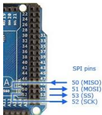
Slika 16. SPI priključci na Arduino AT Mega 2560
