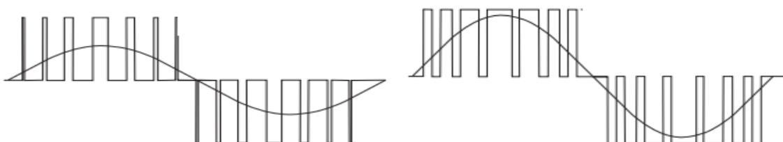
Slika 9. Uključenje prekidača u kraćim razdobljima (lijevo), uključenje prekidača u duljim razdobljima (desno)
