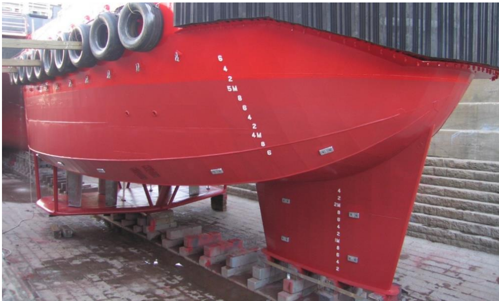
Slika 18. Primjer sustava pasivne katodne zaštite na brodu
