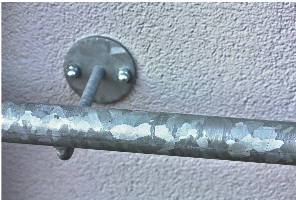
Slika 14. Prikaz karakterističnog uzorka koji posjeduje galvanizirani čelik
