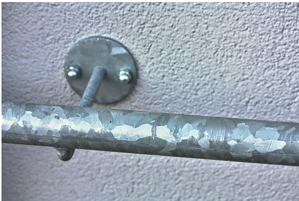
Slika 14. Prikaz karakterističnog uzorka koji posjeduje galvanizirani čelik
