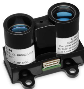
Slika 8: Infracrveni osjetnik udaljenosti
