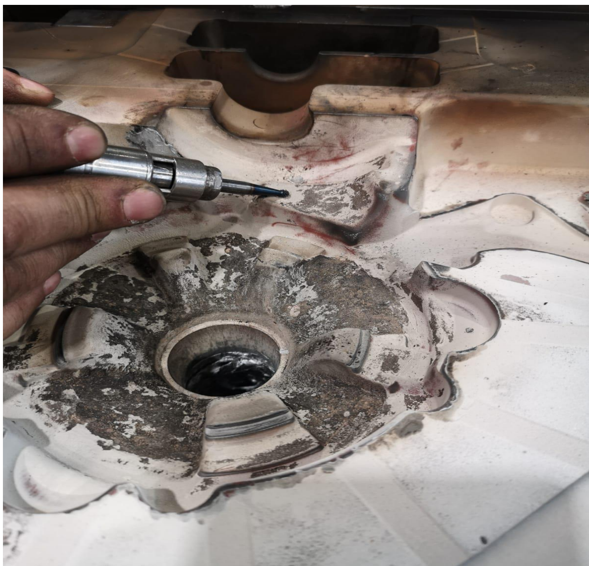
Slika 6: Pregled alata i dodatno čišćenje
