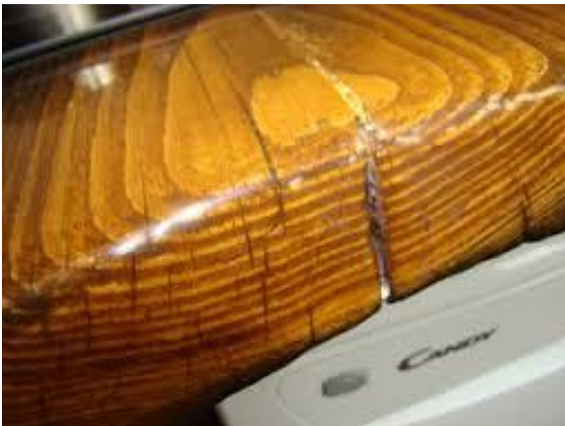
Slika 9. Greška pucanja u dasci
