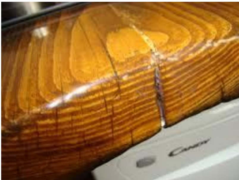
Slika 9. Greška pucanja u dasci
