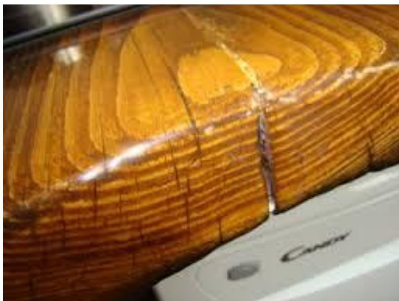
Slika 9. Greška pucanja u dasci
