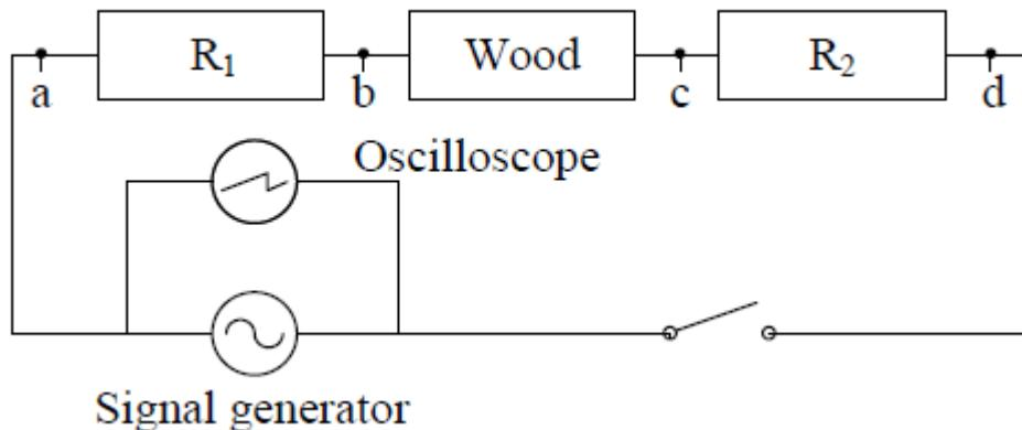
Slika 7: Shema spoja mjerjenja električnog otpora voltmetrom [7].
