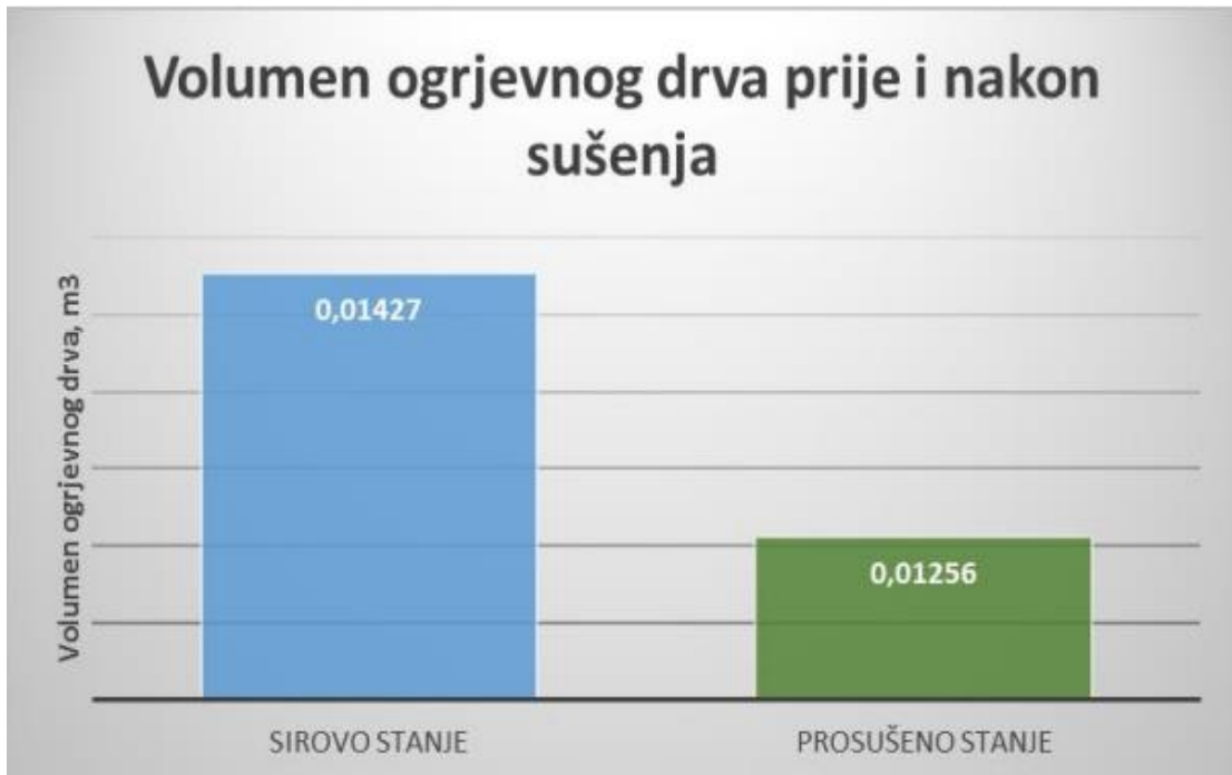
Slika 9: Grafički prikaz promjene volumena ogrjevnog drveta [11].
