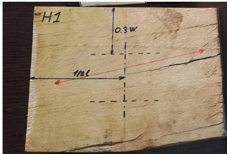
Slika 8: određivanje mesta mjerjenja prema DIN-EN-13183-2:2002 (Autor).
