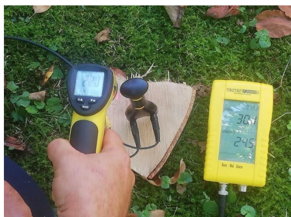
Slika 23: Mjerenje vlage svježeg odsječka 30 mm.
