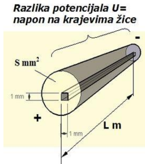
Slika 5: Prikaz zamišljenog vodiča s električnim i relevantnim fizičkim veličinama uz jednadžbu električne otpornosti https://hr.wikipedia.org/wiki/Elektri%C4%8Dni_otpor (18.07.2020.).
