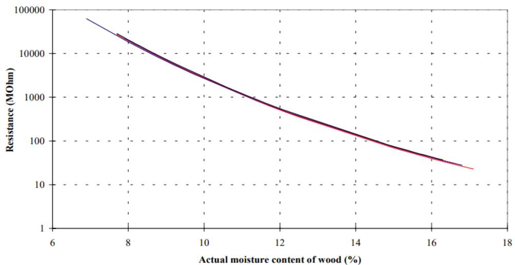
Slika 18: Utjecaj udaljenosti elektroda na mjerene vrijednosti [7].
