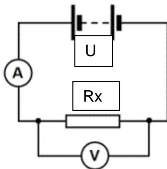
Slika 6: Principijelna električna shema ohm metra,
