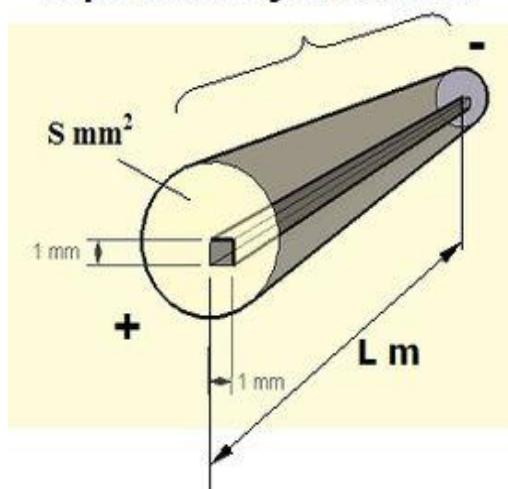
Slika 5: Prikaz zamišljenog vodiča s električnim i relevantnim fizičkim veličinama uz jednadžbu električne otpornosti [https://hr.wikipedia.org/wiki/Elektri%C4%8Dni\\_otporenost](https://hr.wikipedia.org/wiki/Elektri%C4%8Dni_otporenost) (18.07.2020.).
