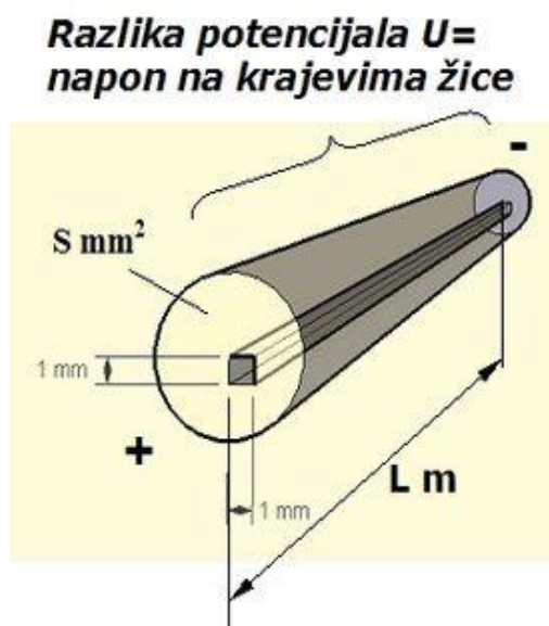
Slika 5: Prikaz zamišljenog vodiča s električnim i relevantnim fizičkim veličinama uz jednadžbu električne otpornosti https://hr.wikipedia.org/wiki/Elektri%C4%8Dni_otpor (18.07.2020.).
