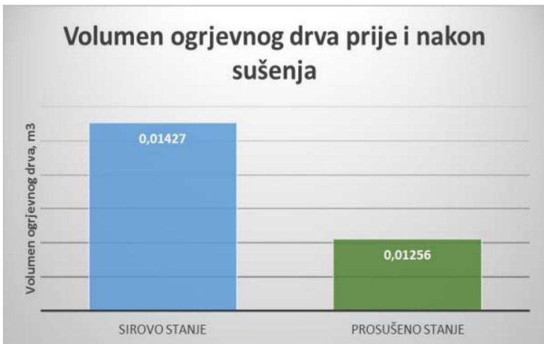
*Slika 9: Grafički prikaz promjene volumena ogrijevnog drveta [11].*
