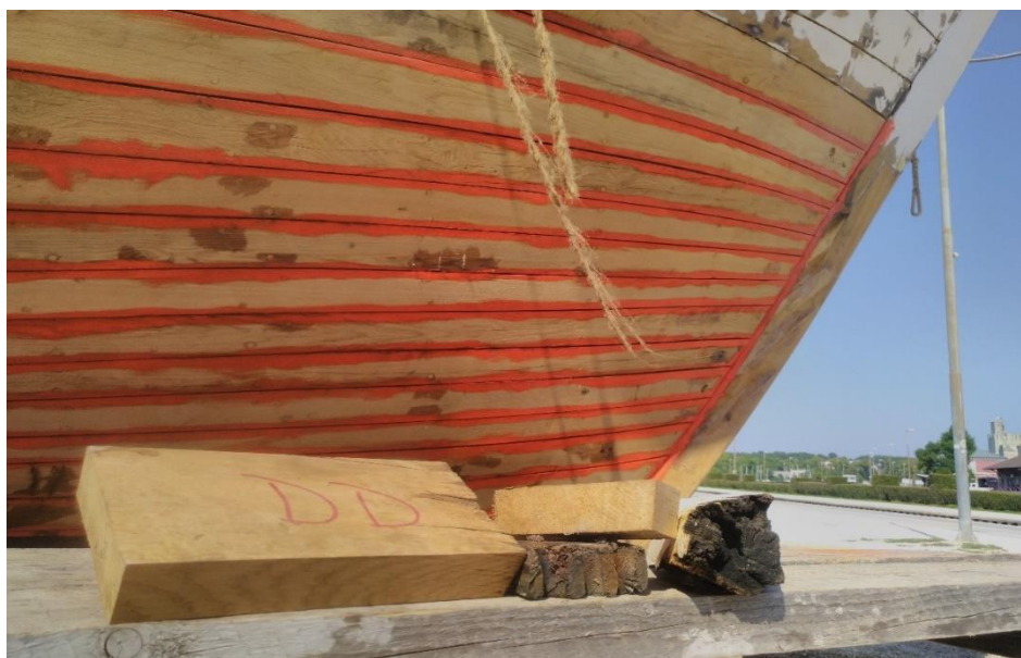
Slika 32: Komadi novog i starog drveta-oplate broad (Autor).
