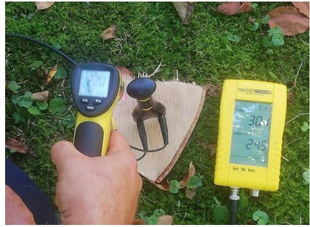
Slika 23: Mjerenje vlage svježeg odsječka 30 mm.
