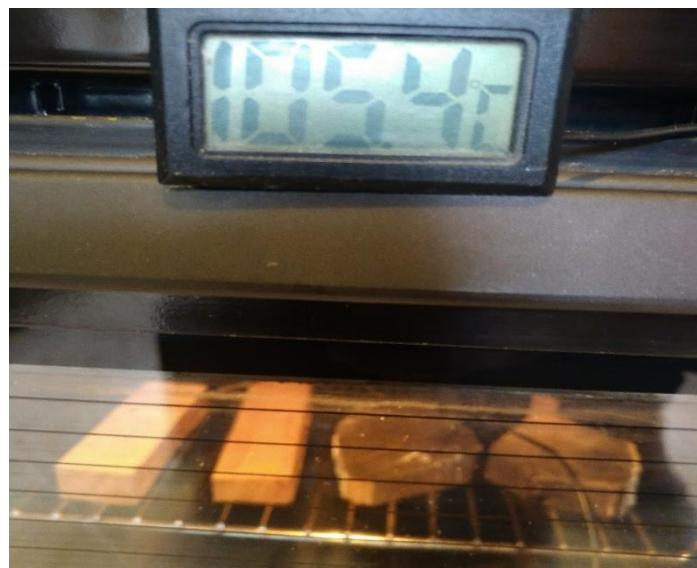
Slika 34: sušenje uzorka uz praćenje temperature (Autor).
