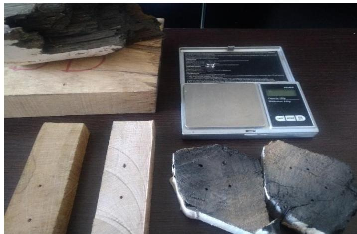
Slika 33: Uzorci drveta kod prvog mjerjenja vlage i mase (Autor).
