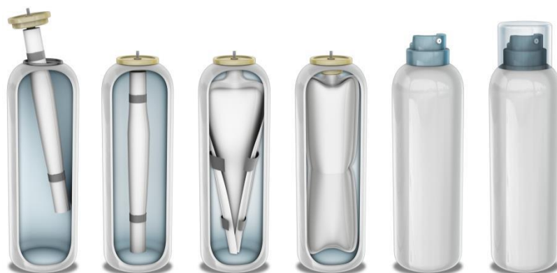
Slika 1. Bag on Valve punjenje
