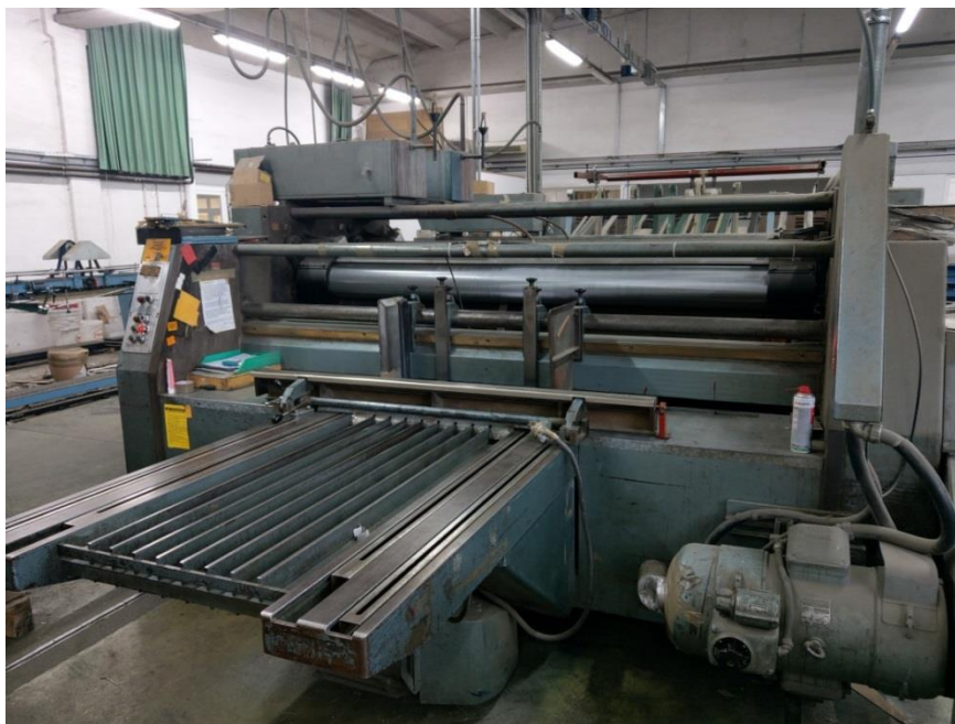
Slika 24: Ulaz slotera (Izvor: Autor)
