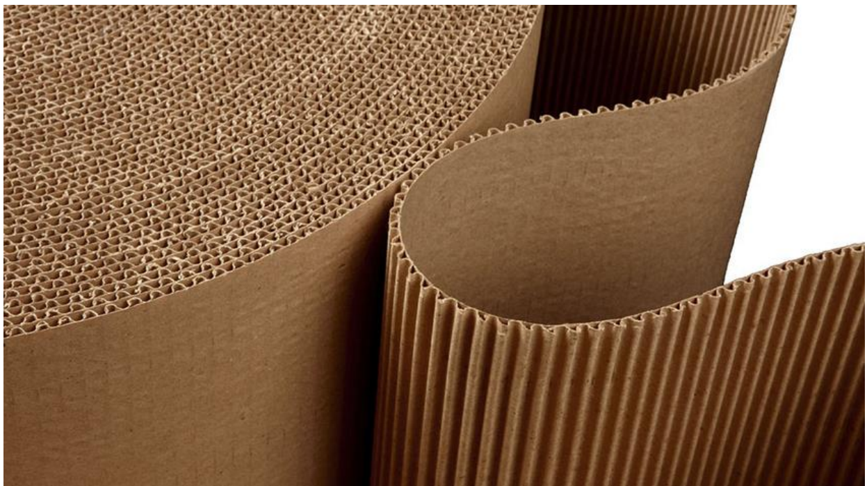
Slika 4: Dvoslojna valovita ljepenka (Izvor: www.panpak.rs/tag/9 )
