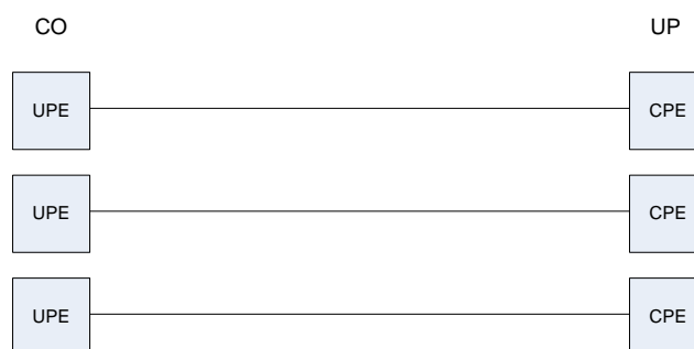
Slika 39: Modul točka-točka P2P
