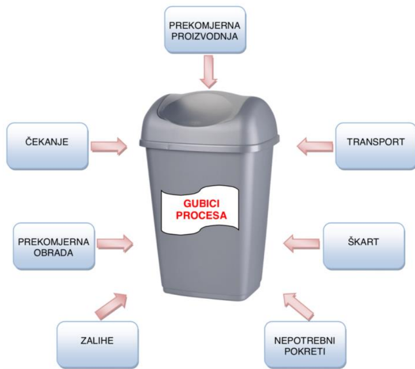
Slika 7 - Prikaz gubitaka/rasipanja u procesu proizvodnje. Izvor: 89
