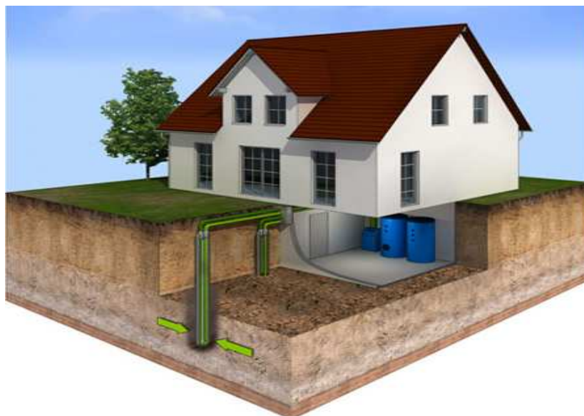
Slika 36. sustav zemljana sonda, izvor www.mcsolar.hr
