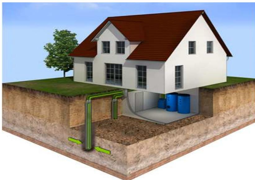
Slika 36. sustav zemljana sonda, izvor [www.mcsolar.hr](http://www.mcsolar.hr)
