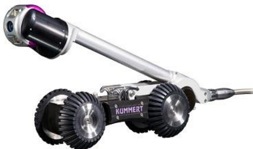
Slika 39: robot kamera za snimanje cjevovoda (izvor: http://www.beton-lab.hr/ )
