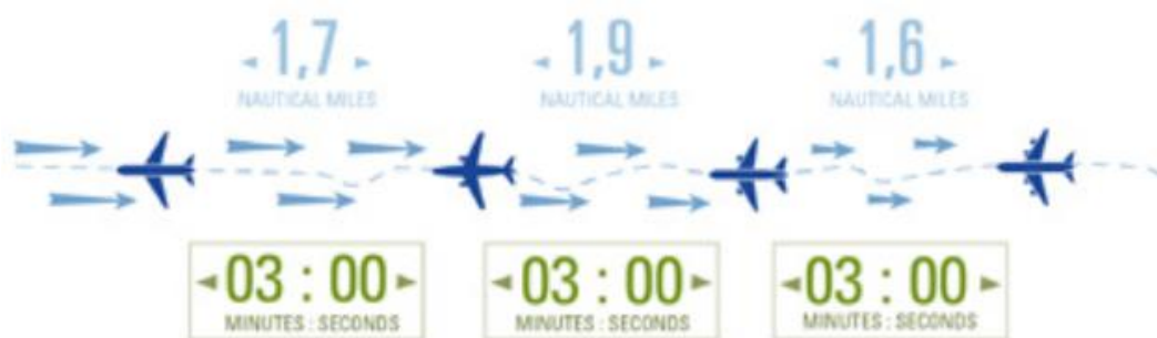
Slika 19. Prikaz sustava vremenskog odvajanja zrakoplova TBS [28]
