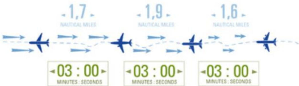
Slika 19. Prikaz sustava vremenskog odvajanja zrakoplova TBS [28]
