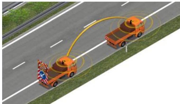
Slika 7. Način rada automatiziranog sustava aFAS [12]
