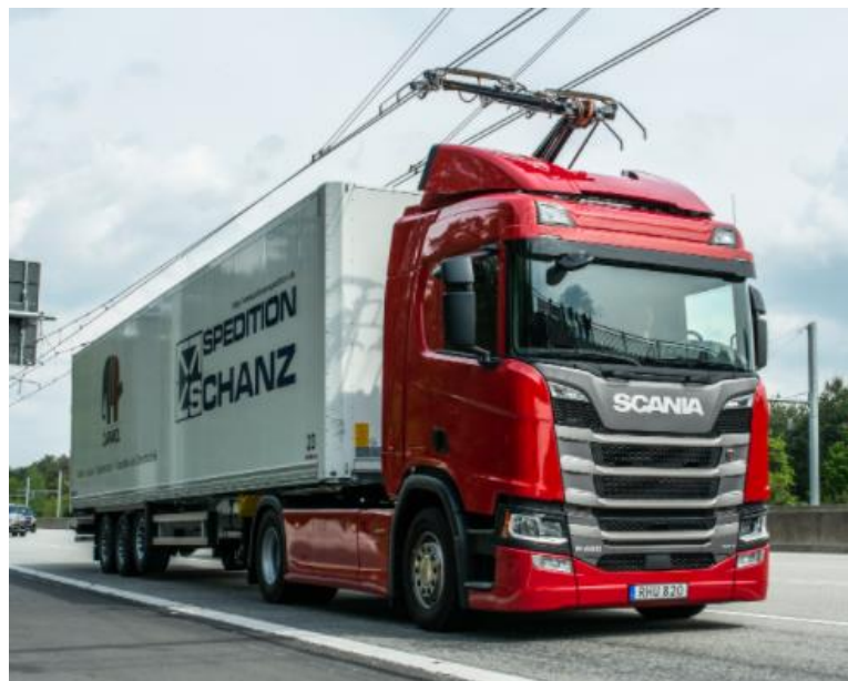
Slika 11. Prikaz spajanja hibridnog kamiona na električne vodove sustavom eLISA [20]
