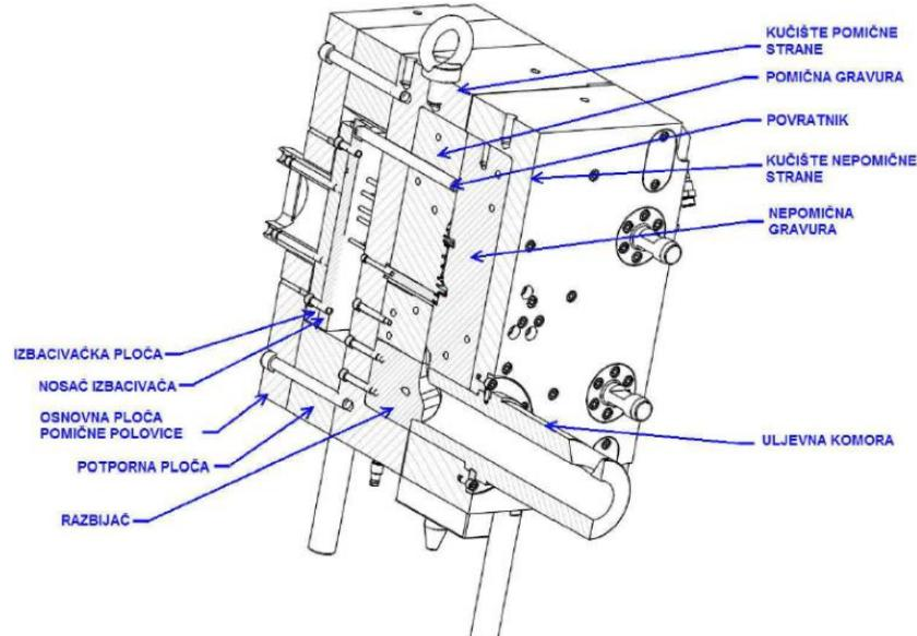
Slika 18. Presjek alata za tlačno lijevanje [7]
