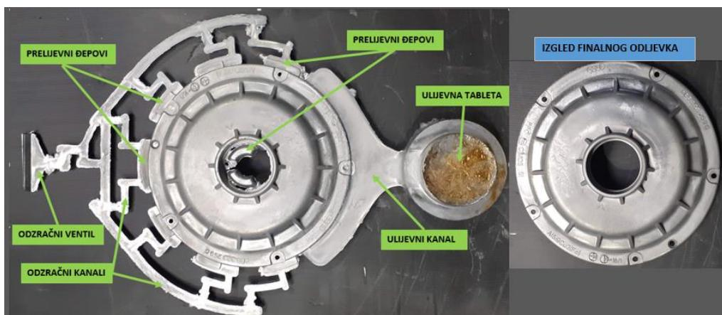
Slika 32. Usporedba odljevka s uljevnim sustavom i finalnog odljevka [Autor]
