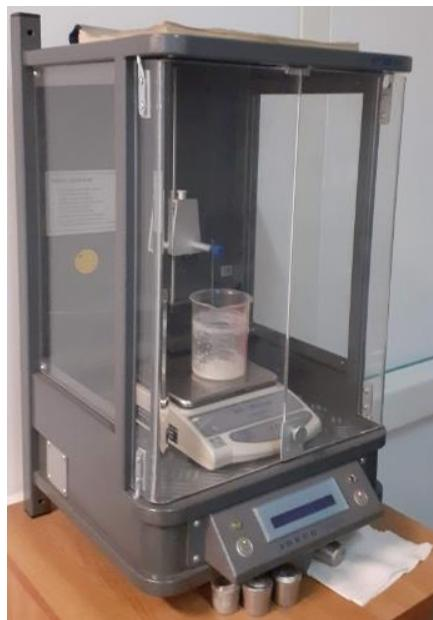
Slika 25. Uređaj za određivanje gustoće uzorka [Autor]
