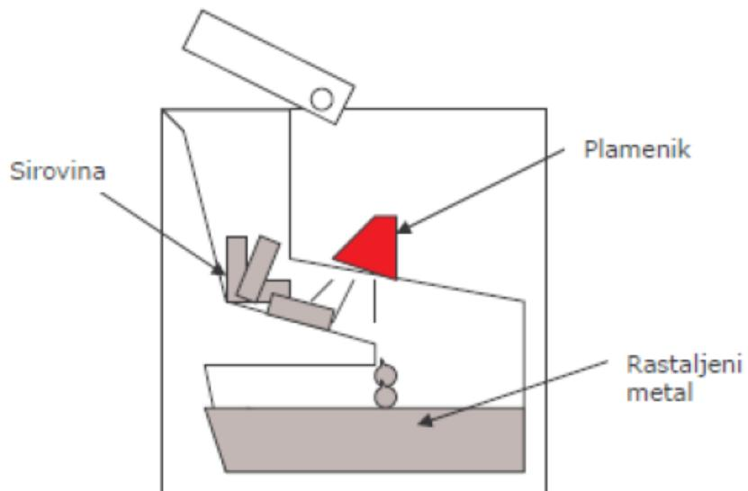
Slika 2. Prikaz taljenja u peći Botta [3]
