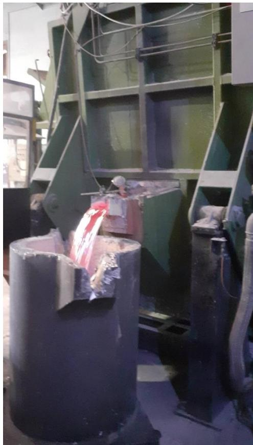
Slika 5. Izljevanje taline iz peći za taljenje Botta u transportni lonac [Autor]
