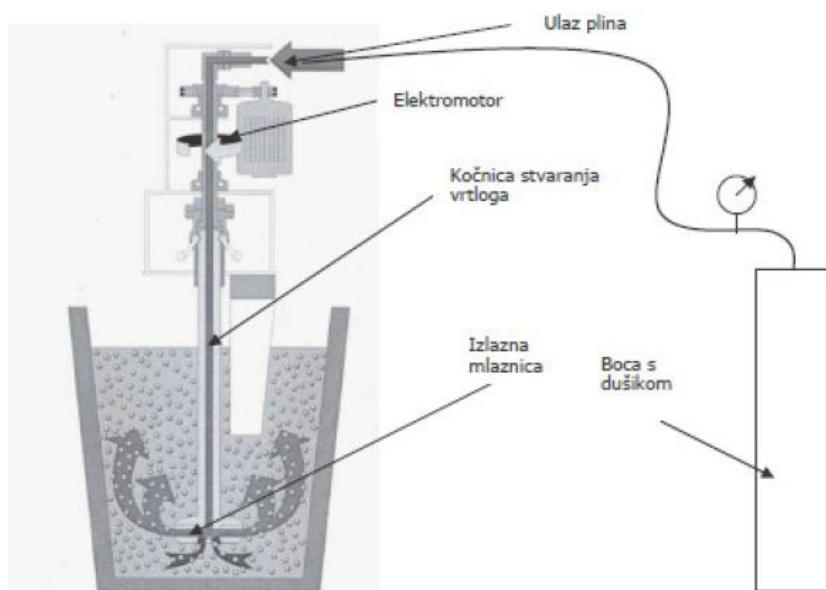
Slika 6. Shematski prikaz djelovanja uređaja za degazaciju taline [1]
