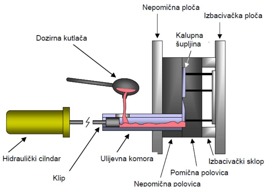
Slika 12. Shema tlačnog lijevanja s hladnom komorom [3]
