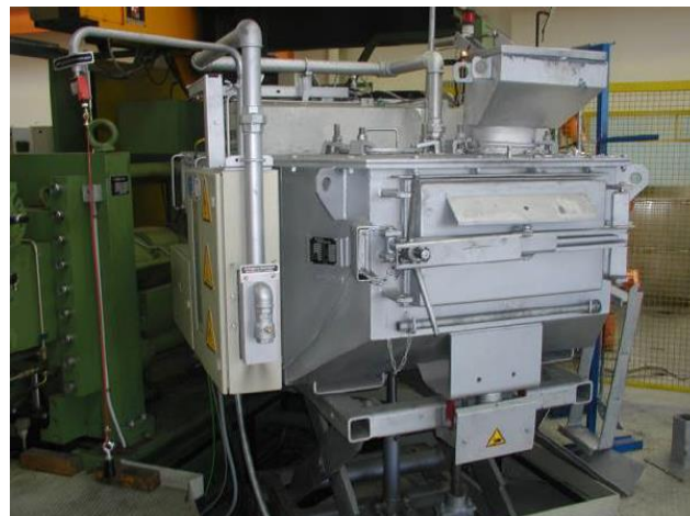
Slika 10. Peć za održavanje temperature taline [3]
