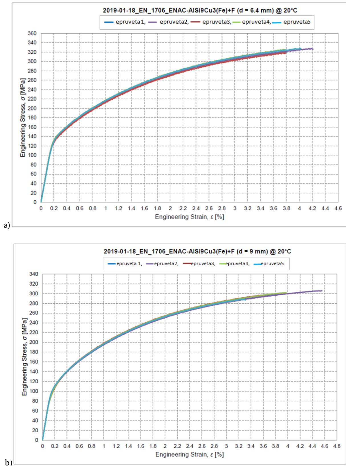
Slika 36. Dijagram istezanja - naprezanja a) epruvete promjera  $d_0$  6,4 mm b) epruvete promjera  $d_0$  9 mm [Autor]
