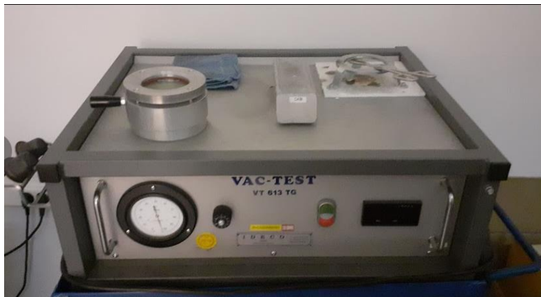
Slika 24. Uređaj za ljevanje uzorka sa skrućivanjem pod vakuumom [Autor]
