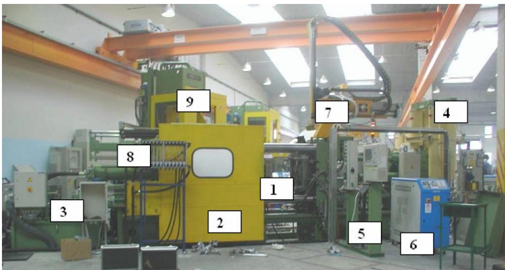
Slika 8. Izgled čelije s osnovnim elementima: : 1. stroj za tlačno lijevanje, 2. zaštitna vrata, 3. hidraulički agregat, 4. akumulatori II i III faze, 5. upravljački ormari, 6. jedinica za temperiranje alata, 7. automat za premazivanje alata, 8. mjerači protoka, 9. preša za obrez [3]
