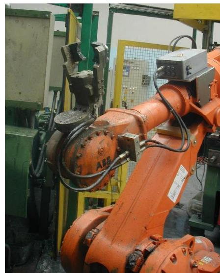
Slika 9. Robot za iznos odljevaka [3]
