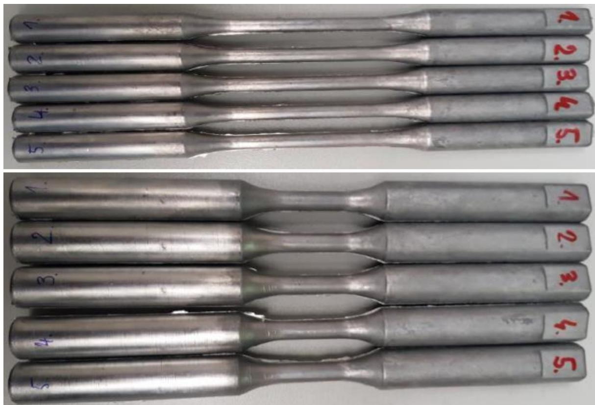
Slika 35. Epruvete za ispitivanje [Autor]
