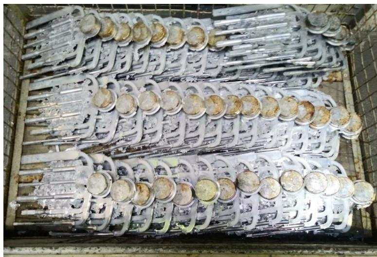
Slika 34. Sanduk sa odlivenim uzorcima za ispitivanje [Autor]
