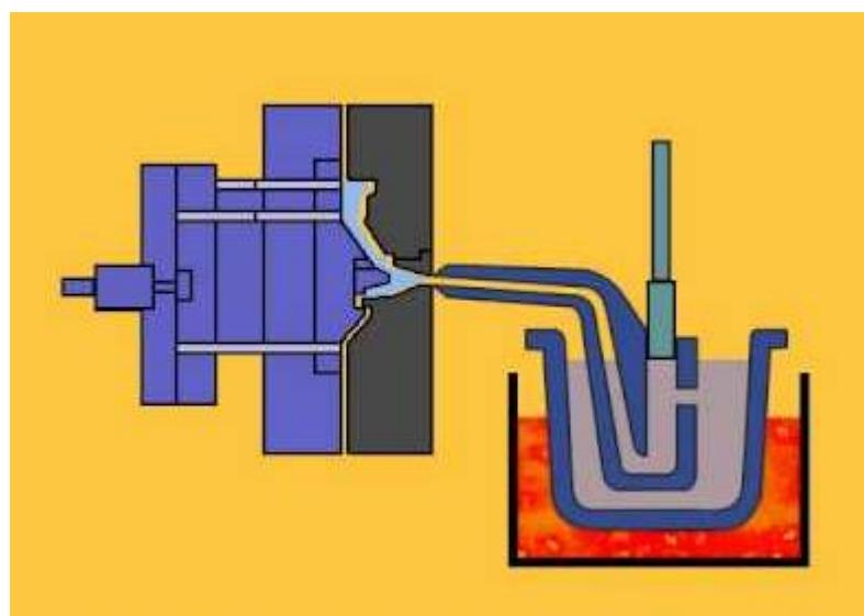
Slika 11. Shema tlačnog lijevanja s topлом komorom [11]
