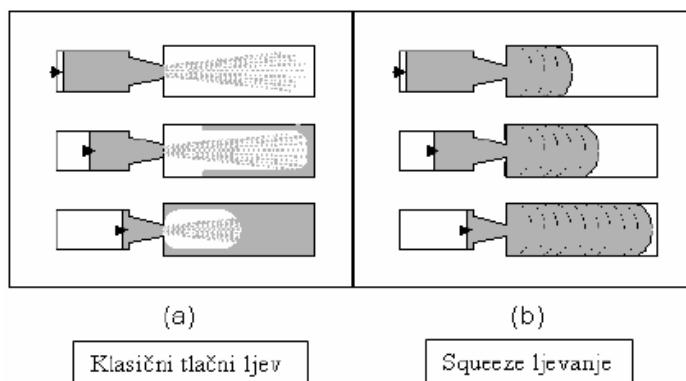
Slika 16. Usporedba klasičnog i squeeze načina tlačnog lijevanja [3]
