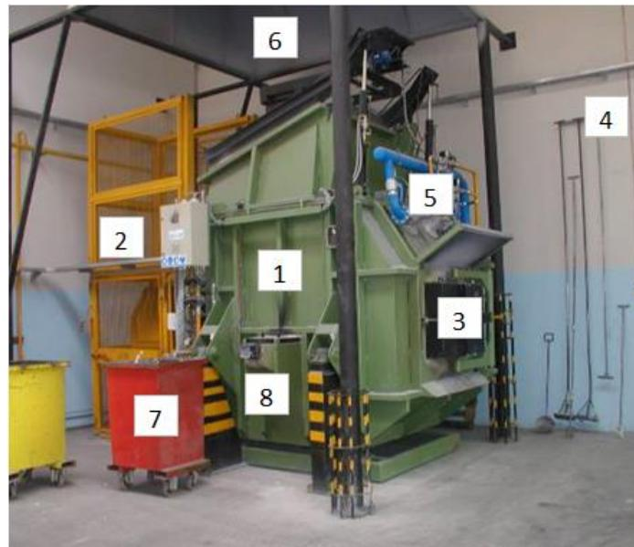
Slika 1. Peć Botta i prikaz glavnih dijelova peći: 1. peć, 2. lift za ukrcaj transportnih kolica, 3. vrata za čišćenje peći, 4. pribor za čišćenje peći, 5. plamenici, 6. napa za dimne plinove 7. transportna kolica i 8. otvor za izljevanje slitine. [3]
