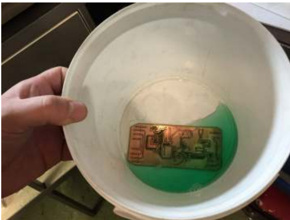
Slika 42. Materijal „BDM“ modula pri kraju procesa jetkanja
