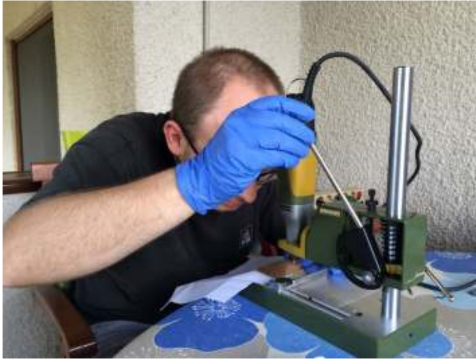
Slika 44. Bušenje rupa kroz tiskane pločice modula
