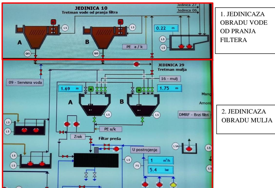
1. JEDINICA ZA OBRADU VODE OD PRANJA FILTERA
