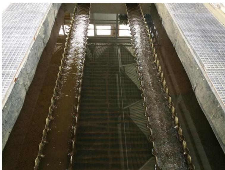
Slika 27: Pločasti taložnik sa vidljivim flokulama mulja [14]
