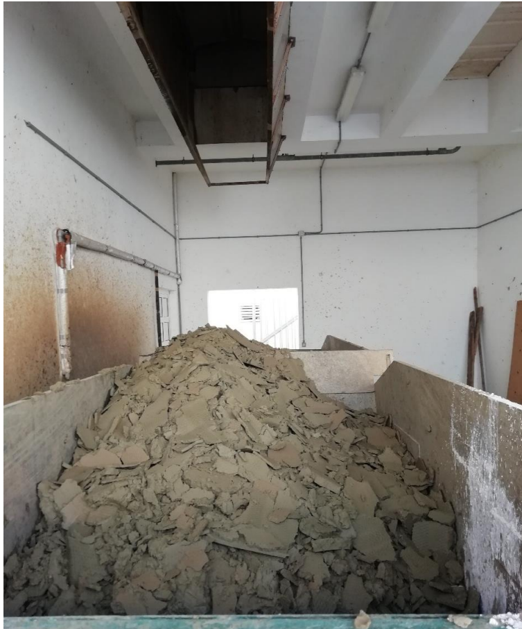
Slika 11: Filterski kolač mulja [Autor]
