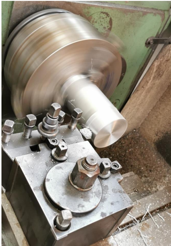
Slika 11: Izrada aluminijskog bloka
