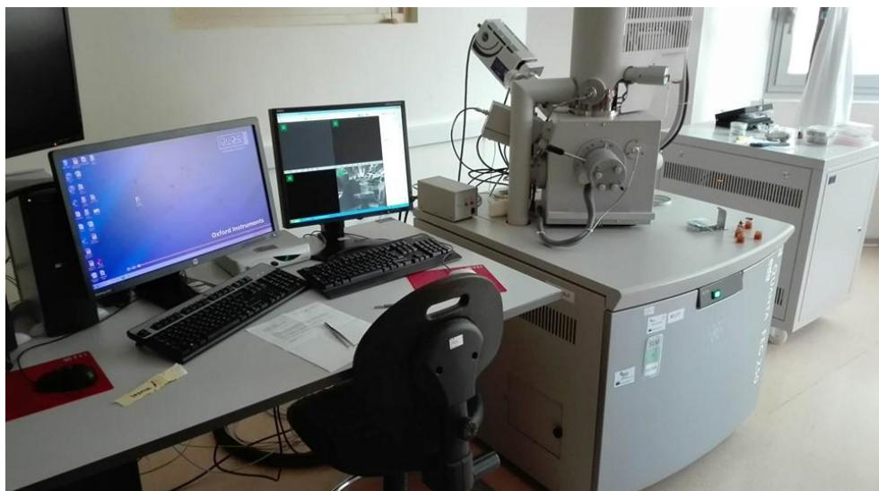
Slika 8. Pretražni elektronski mikroskop FEG QUANTA 250 SEM FEI s računalnom podrškom.
