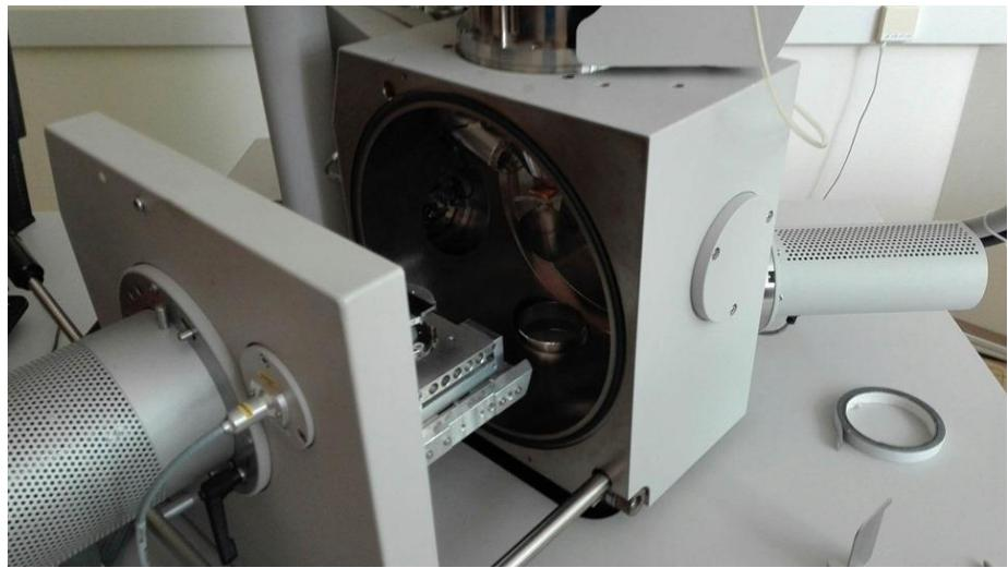
Slika 9. Komora za ispitivanje uzorka (FEG QUANTA 250 SEM FEI)
