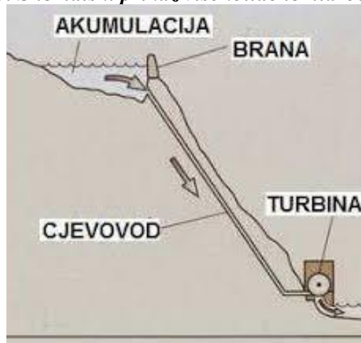
Slika 10. Shematski prikaz visokotlačne hidroelektrane
