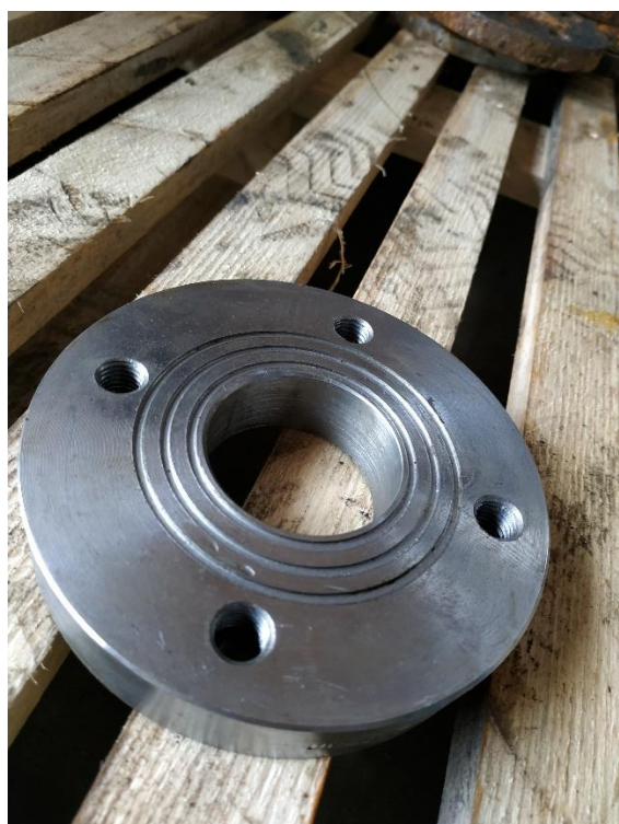
Slika 47. Prirubnica za pojačanje sa slijepim rupama 64
