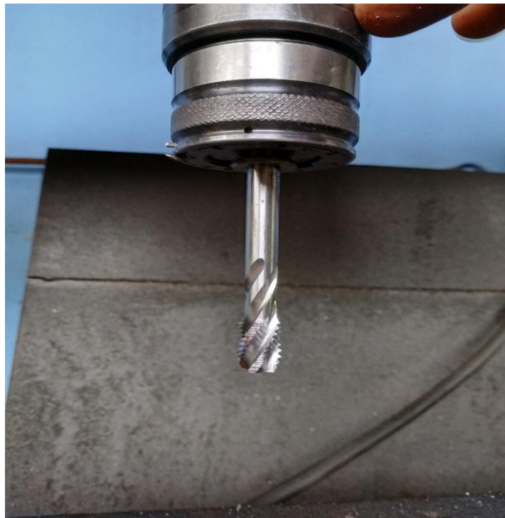
Slika 26. Glodalo za urezivanje navoja 35
