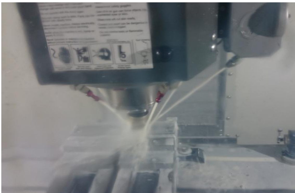
Slika 36. Primjena SHIP-a pri obradi odvajanjem čestica 45
