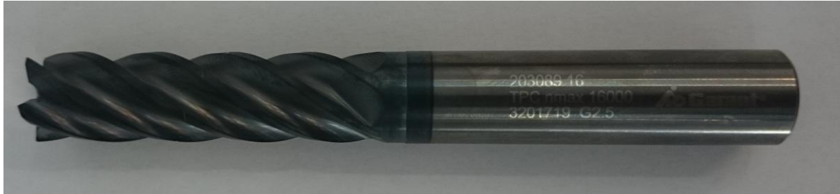
Slika 25. TPC glodalo za čelik 34
