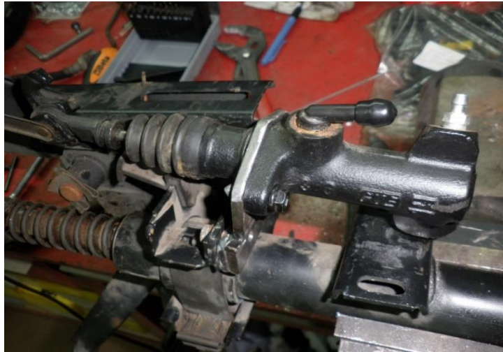
Slika 7. Glavni cilindar kvačila 9
