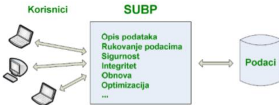
Slika 2: Funkcije sustava za upravljanje bazom podataka
