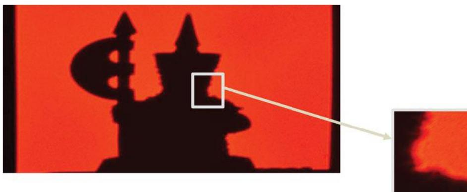
**Slika 4.** Pregled rubnog osvjetljenja Fresnelov-og i Fraunhoferov-og holograma
