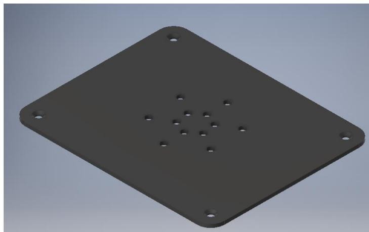
**Slika 27.** Model poklopca kućišta
